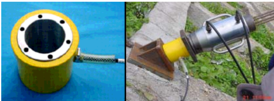
圖 10-10 地錨荷重計安裝設置情況
