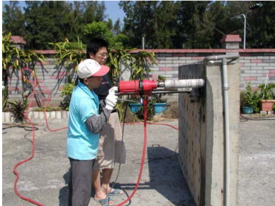
照片 3.1 混凝土試驗牆鑽心試驗
