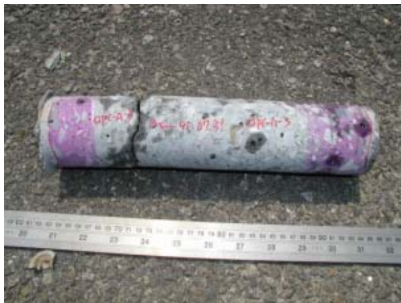
照片 4.2 95 年量測中性化較為嚴重的 OPC 混凝土試體
