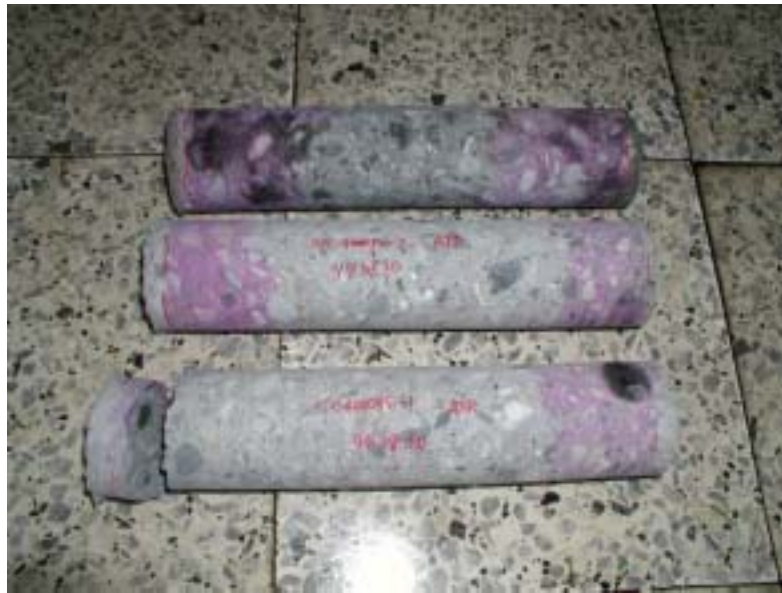
照片 4.1 94 年量測中性化較為嚴重的 OPC 混凝土試體
