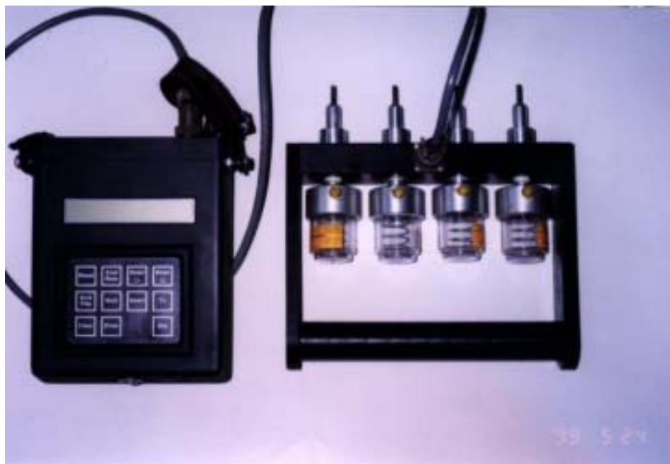
照片 3.3 混凝土電阻係數量測儀
