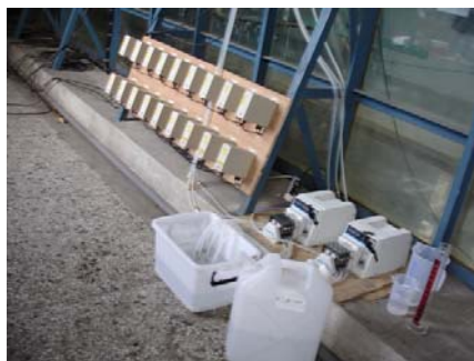
蠕動泵浦及導電度計轉換器
