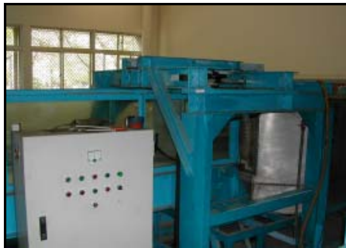
圖 7-5 造波機及蓄水池
