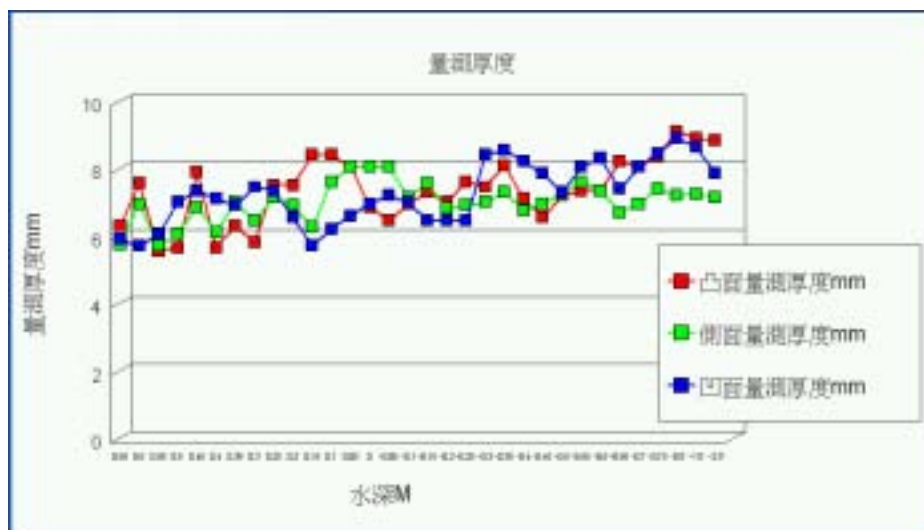
圖 3.10 蘇澳港鋼板凸側凹三面厚度比較圖
