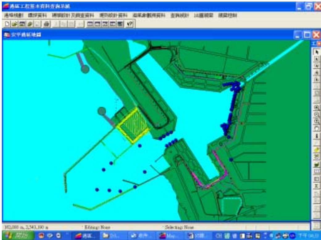
圖 6-18 安平港區鑽探孔位分佈圖
