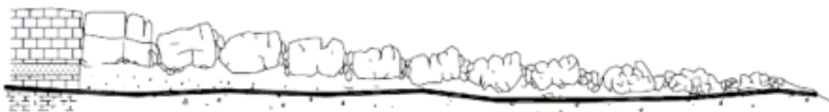
(b) 岩石側移破壞型態之二
