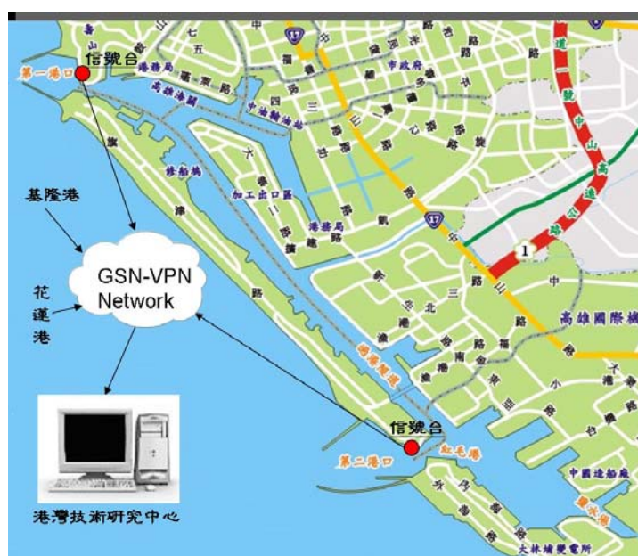
圖 3-70 即時影像傳輸整體通訊架構圖
