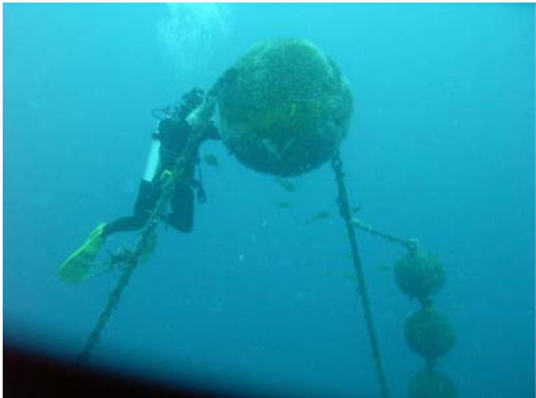
照片 2.15 花蓮 3.0M DATA BUOY 海氣象觀測儀器檢查保養情況
