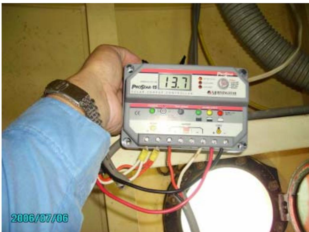
照片 2.10 安平海上觀測樁警示燈標檢查保養
