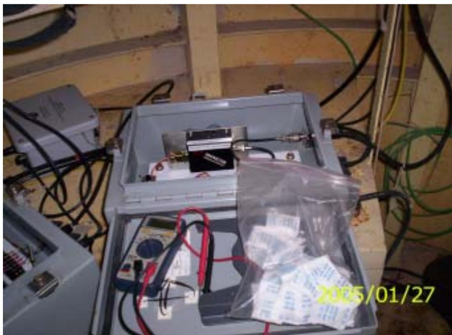
照片 2.6 觀測樁內儀器控制箱更換乾燥包
