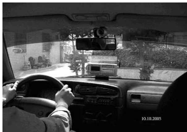
圖 2-2 錄影設備車上安裝方式
