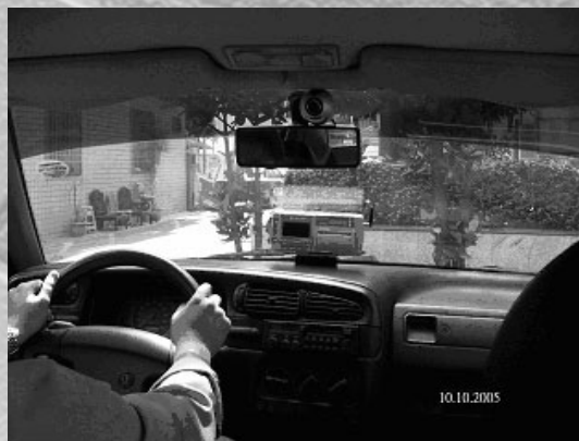
圖2-2 錄影設備車上安裝方式
