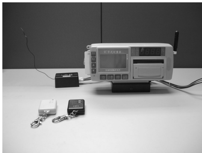
圖 2-5 無線式緊急按鈕連結方式
