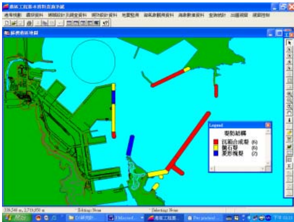
圖3-5 蘇澳港區堤防結構型式主題圖
