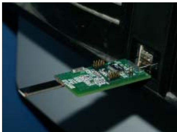
圖 15 射頻 RF 無線傳輸接收元件與電腦接合之情形
