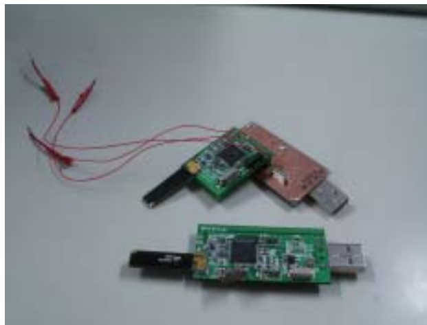
圖 12 射頻 RF 無線傳輸元件含發射及接收元件
