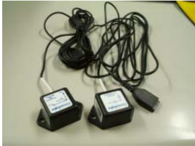
圖 13 Crossbow 加速度計及傾角計等感測器
