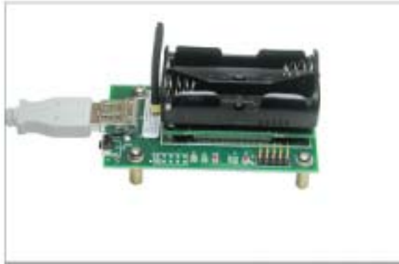
圖 11 MIB520CA 接合 MICAz 以及 Sensor Board 的情形 ( 圖片來源： http://www.xbow.com )
