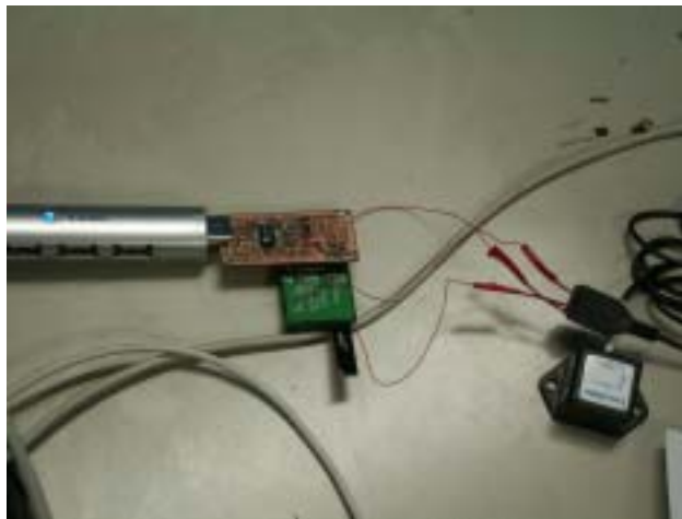
圖 14 感測器與射頻 RF 無線傳輸發射元件之接合情形
