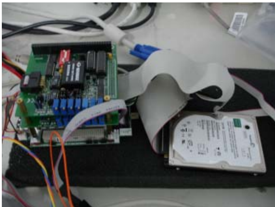
圖 4.6 控制電腦及 DAC 界面卡
