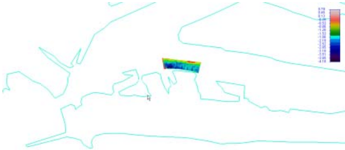
圖 23 浚挖第一區水深變化色階圖
