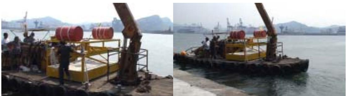
(左) 600kHz AWCP 頗面流速波浪儀 (右) 電池筒
