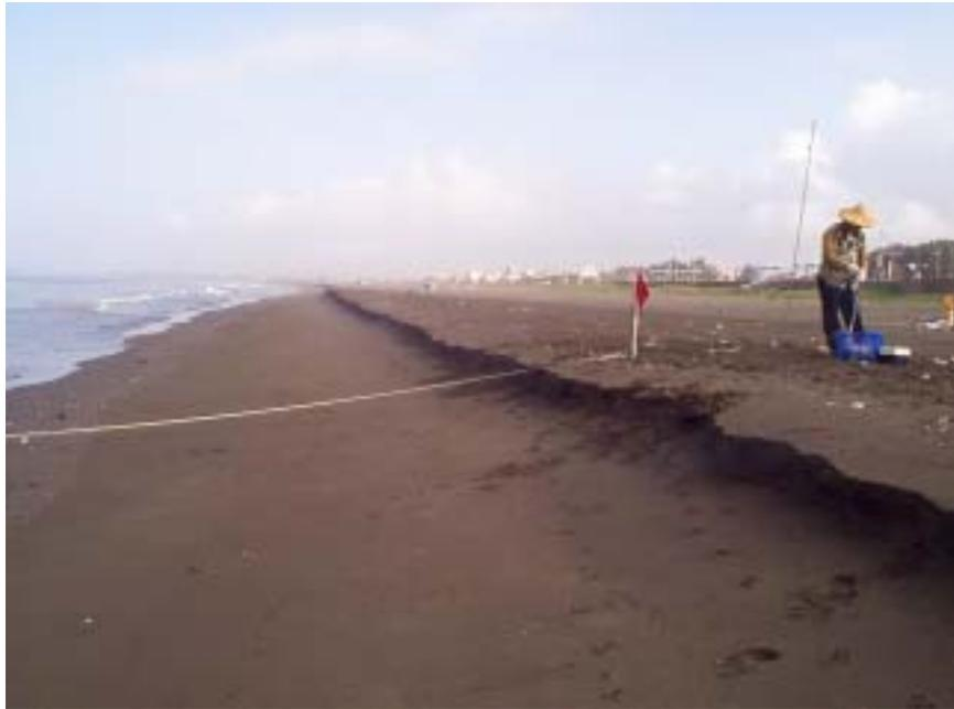
圖 3.15 灘面出現波浪侵蝕作用所造成之斷崖結構
