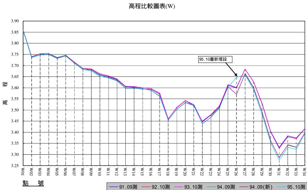
圖 5.7 蘇澳港南外堤沉箱堤面各 W 點之歷年高程變化比較
