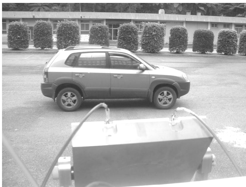
圖 4.3-5 FMCW 雷達系統之戶外實際量測圖
