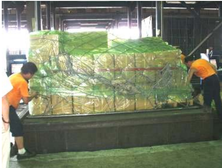
圖 7.6 打盤作業示意圖(三)
