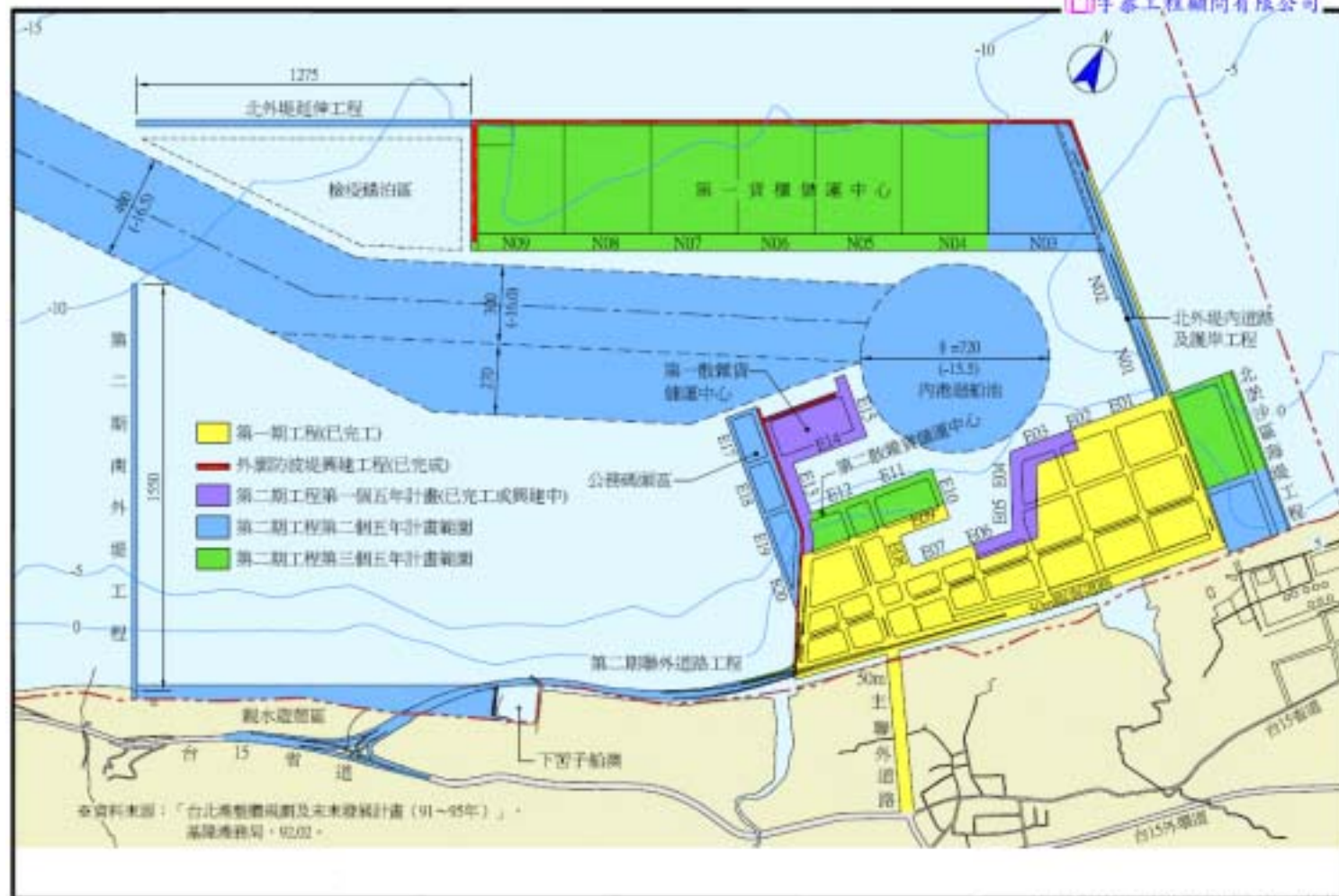
圖 2-2 臺北港二期工程平面配置圖
