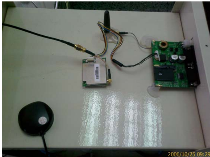
圖 5.8 整合資料傳送平台實體 ( GPS 及 CDMA 模組 ) 照片
