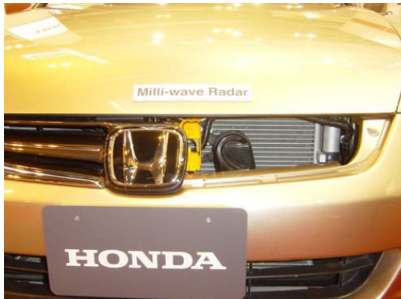
圖 2-1 適應性巡航系統所使用之毫米波雷達[6]
