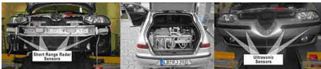
圖 2-16 超音波(低速短距離偵測)與雷達(高速長距離偵測)感測器安裝位置[19]
