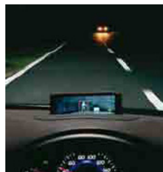
圖 2-32 HONDA 碰撞減緩煞車輔助系統以及智慧型夜視輔助系統[19]
