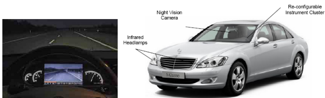
圖 2-30 Mercedes S-Class 先進夜視輔助系統與可調變儀錶板[19]
