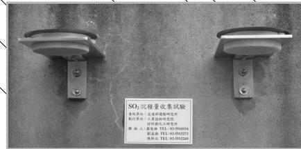
為減少吸附酸雨沉降或懸浮硫酸氣體，試驗盤朝下放置
