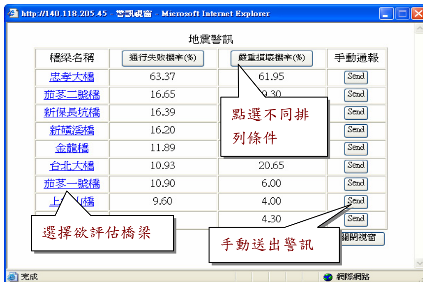
圖 3-262 可能破壞橋梁清單
