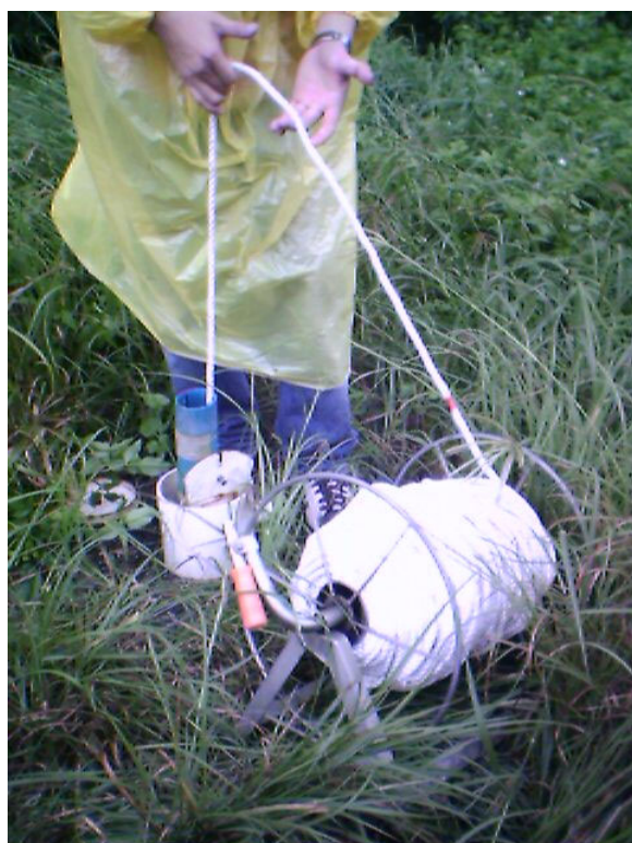
圖 2.6 傾斜觀測管管內檢查過程圖
