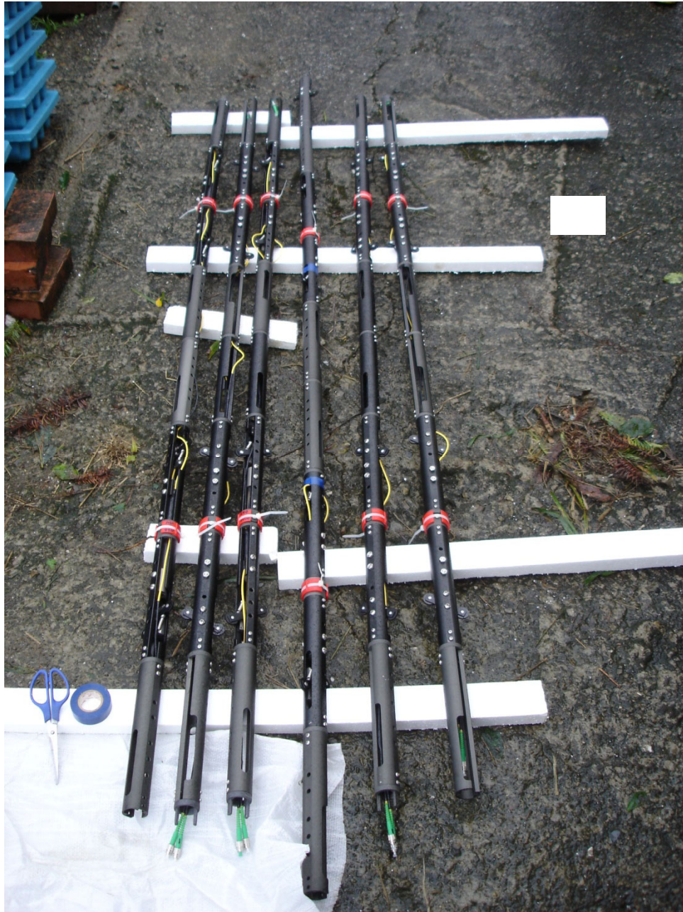
圖 4.2 節理式光纖光柵偏斜儀實體圖
