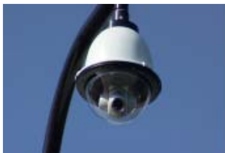
圖 3-5-4 攝影機吊架與室外保護罩
