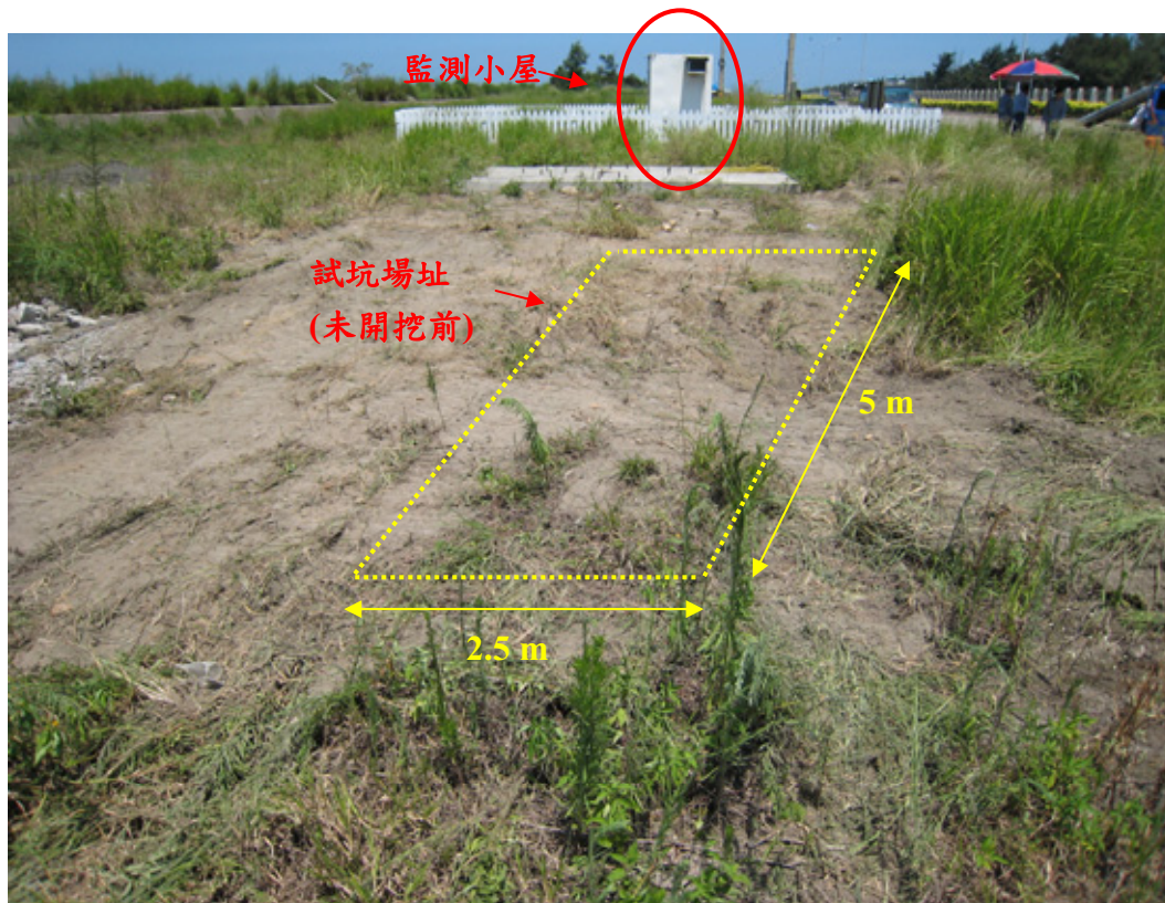
圖 4-8 現地試驗場址(未開挖前)
