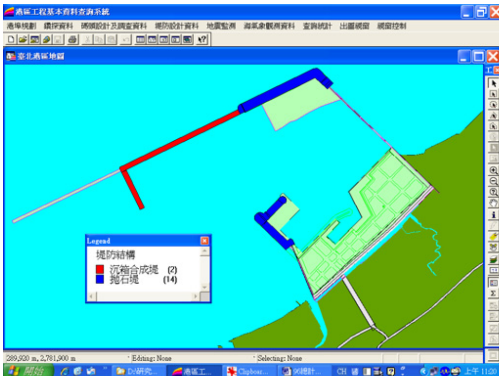
圖10-5 臺北港區堤防結構型式主題圖
