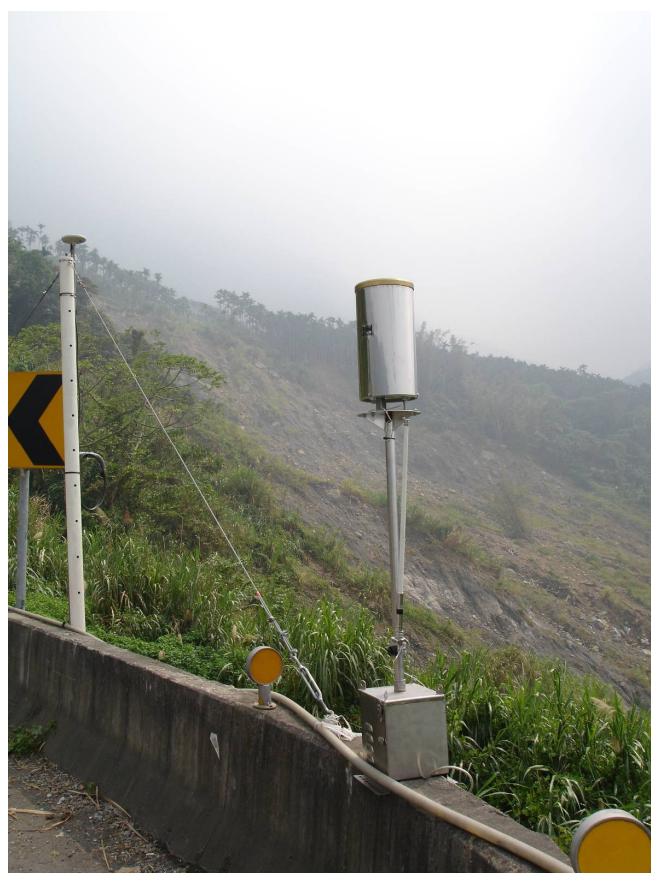
圖 3 - 22 第四彎雨量計裝設位置圖
