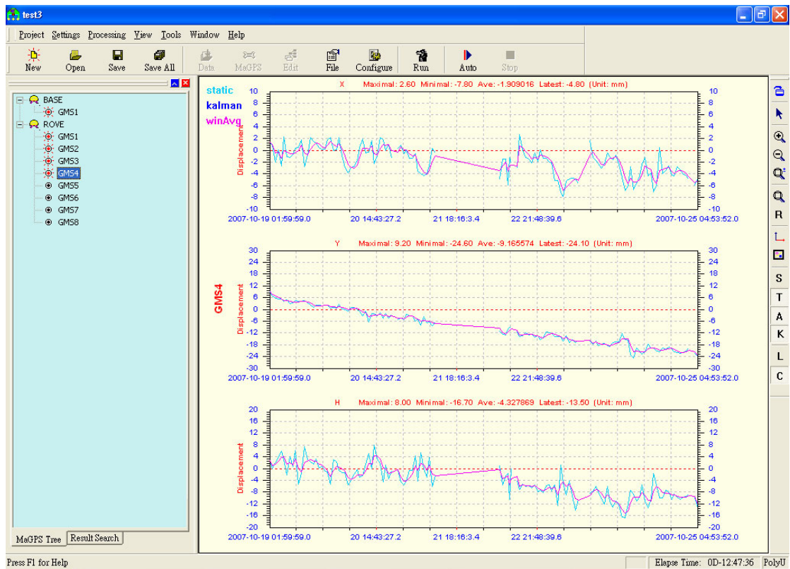
圖 3-56 道路邊坡自動化監測系統（第四號天線）
