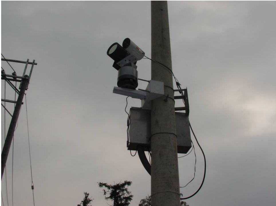
圖 2-2 臺 18 線 45K CCD 攝影機及紅外線投射燈
