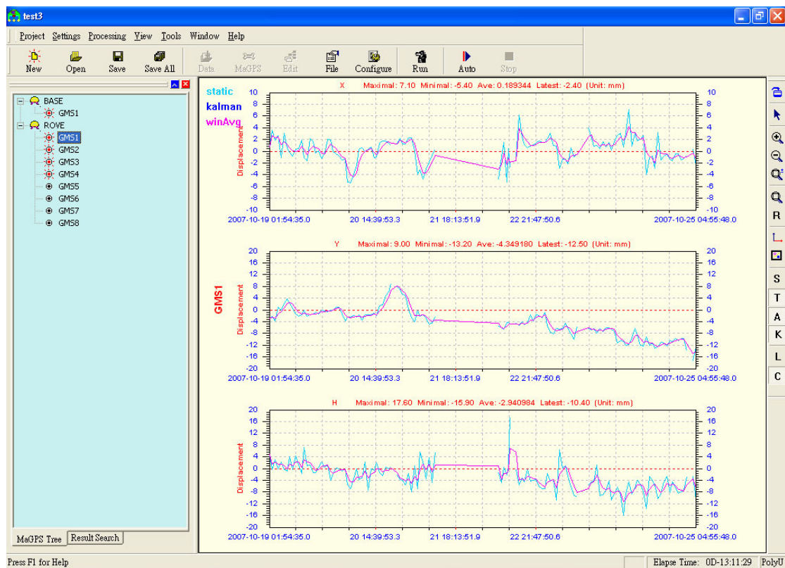
圖 3-53 道路邊坡自動化監測系統（第一號天線）
