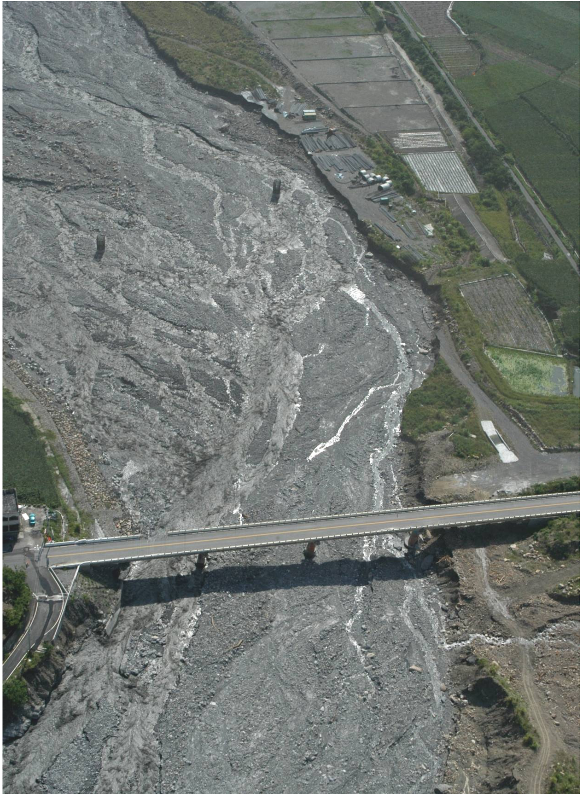
圖 4-46 敏督利颱風過境上游主流緊逼左岸；下游側呈瓣狀流路
