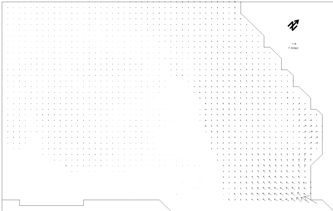
圖 5.19 高灘地與主深槽取不同曼寧 n 值減去各格點為相同曼寧 n 值(退潮)
