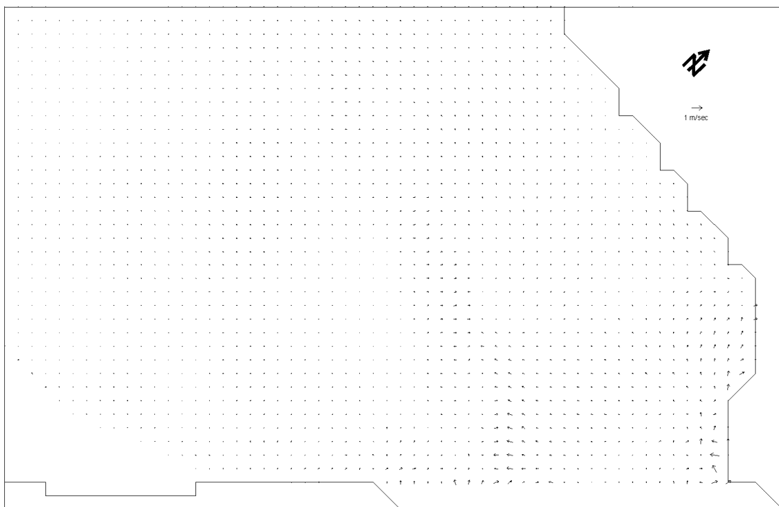
圖 5.20 高灘地與主深槽取不同曼寧 n 值減去各格點為相同曼寧 n 值(漲潮)
