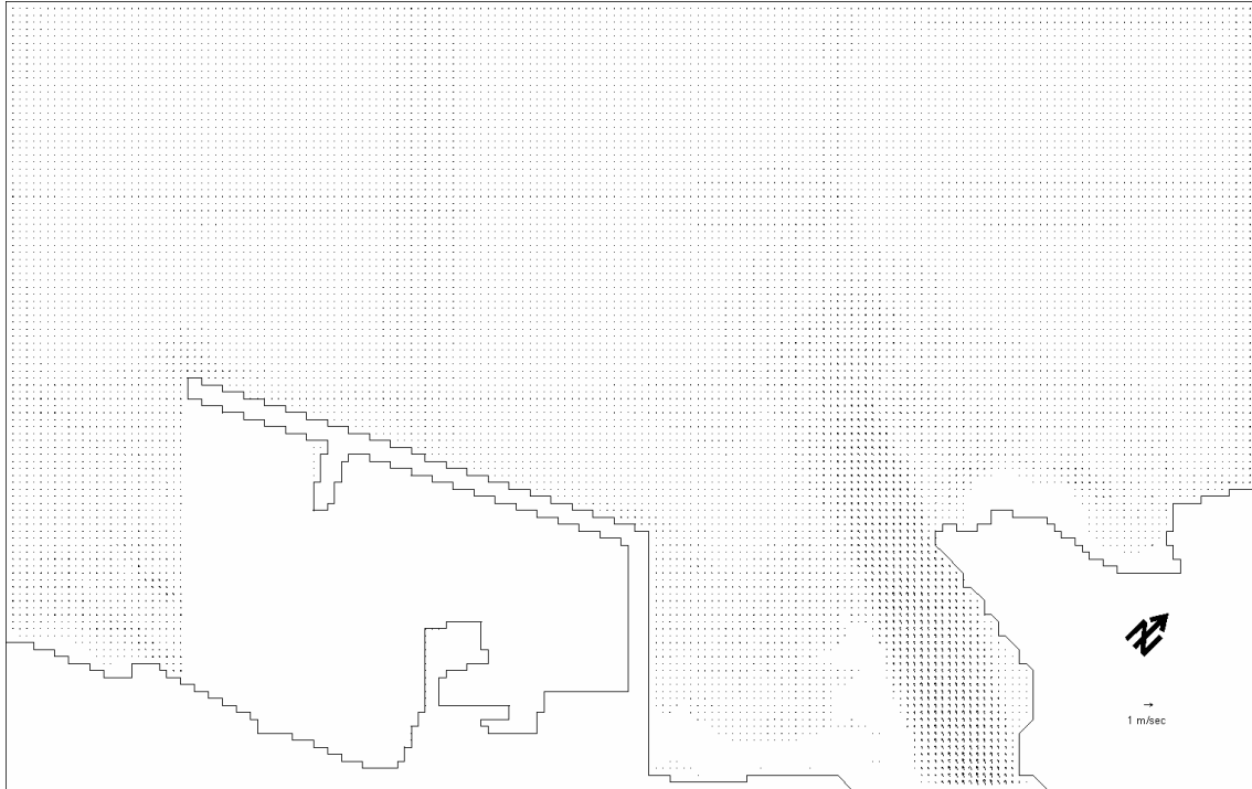
圖 5.15(b) 未考慮海流的條件淡水河口海域退潮時之流場
