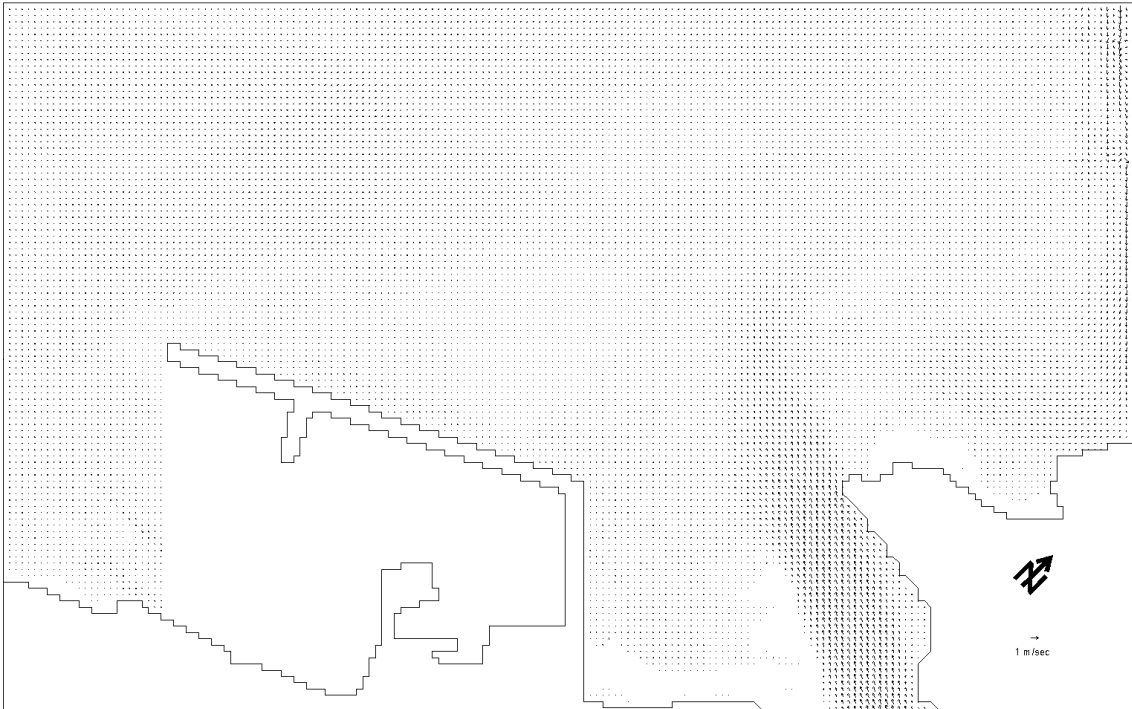
圖 5.15(a) 考慮海流的條件淡水河口海域退潮時之流場
