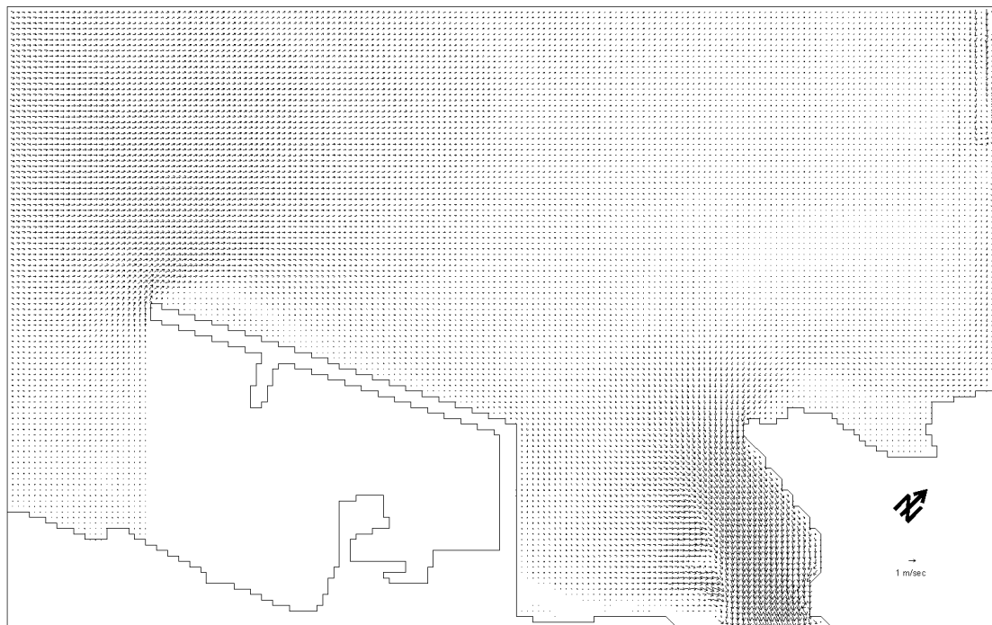
圖 5.14(a) 考慮海流的條件淡水河口海域漲潮時之流場
