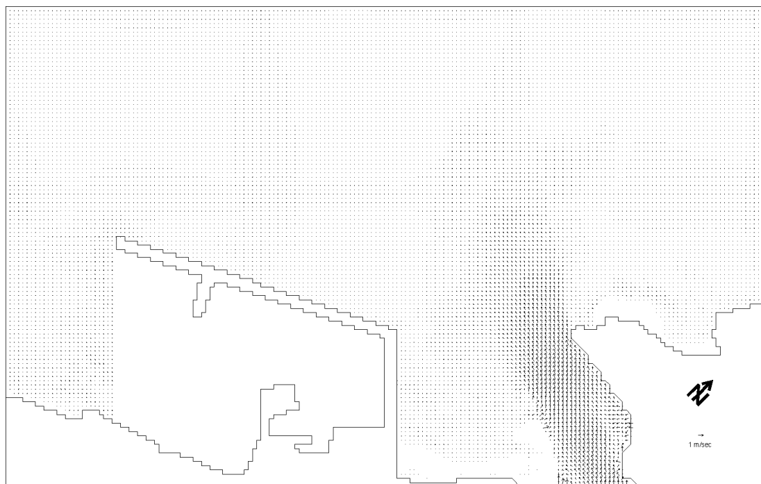
圖 5.10 重現期 100 年豪雨洪水期間臺北港鄰近海域及淡水河河口流場 (退潮)
