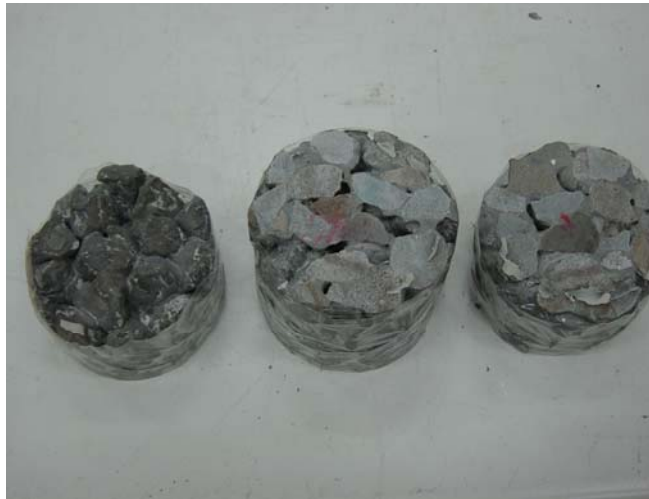
照片 4.4 透水混凝土分三層
