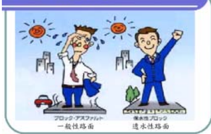
圖3 不同鋪面之熱島效應示意圖
