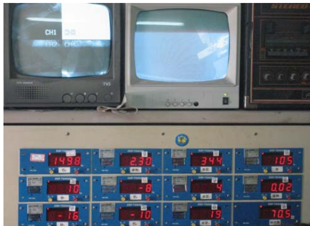
照片 6.2 預拌廠操作台透水混凝土配比資訊
