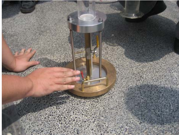
照片 4.6 現場透水試驗儀器
