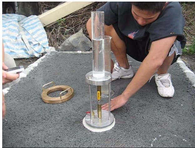
照片 6.5 預拌廠試鋪透水混凝土現場透水量試驗
