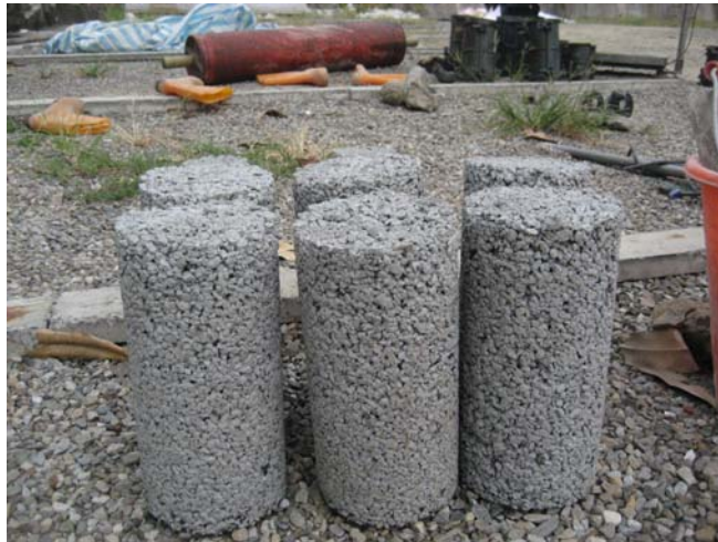
照片 6.17 現地透水混凝土試體
