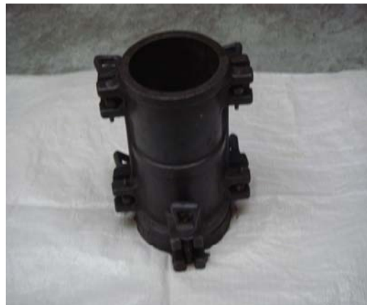
照片 4.2 \Phi 10\text{cm} \times 20\text{cm} 圓柱試體模
