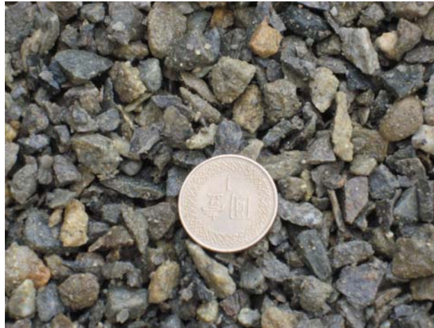
照片 6.1 試拌料碎石約 5mm 骨材粒徑
