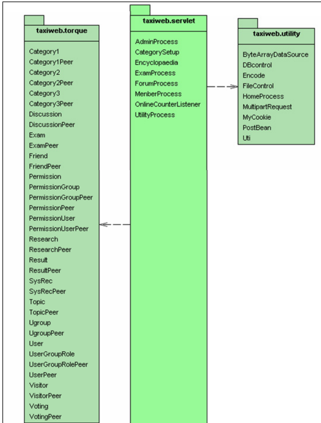
圖 6-3 taxiweb.servlet Package Diagram
