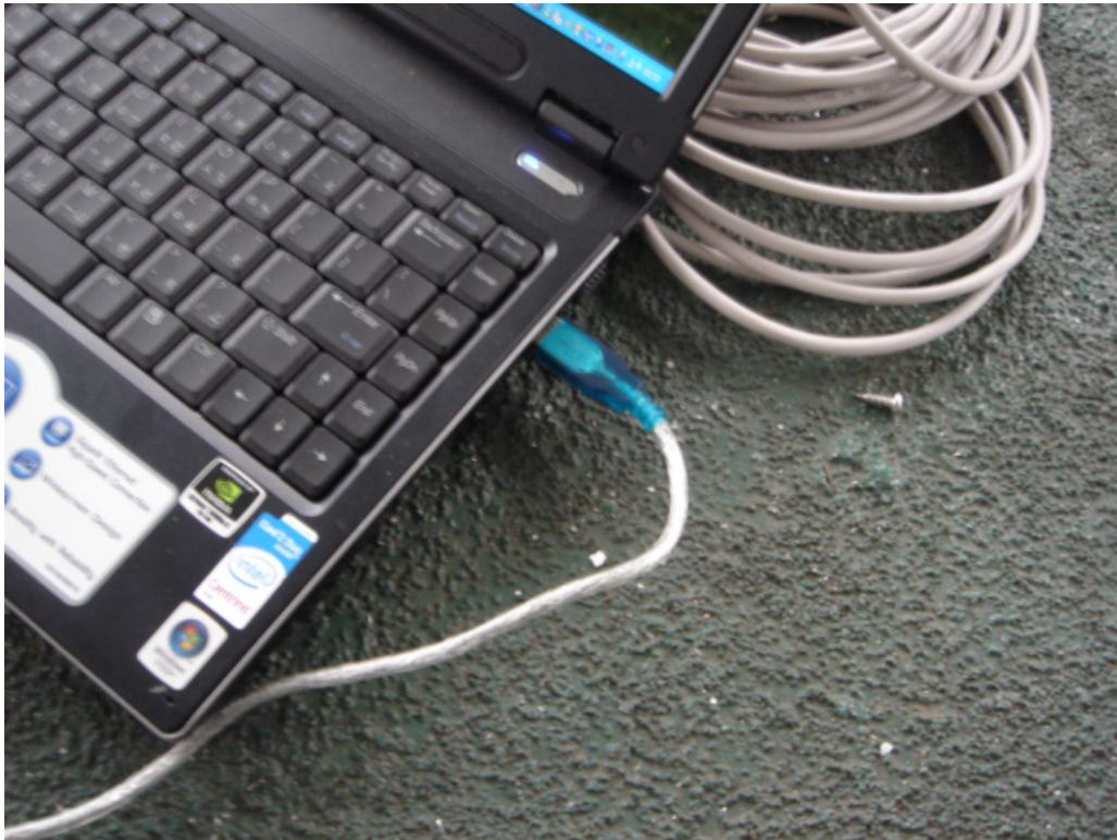
圖 4.69 使用 RS232 串列通訊埠，使 PLC 與 PC 連結(二)
