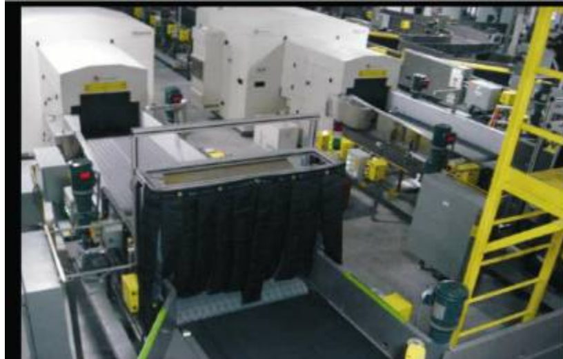
圖 2.30 X 光檢驗與 RFID 追蹤通道
