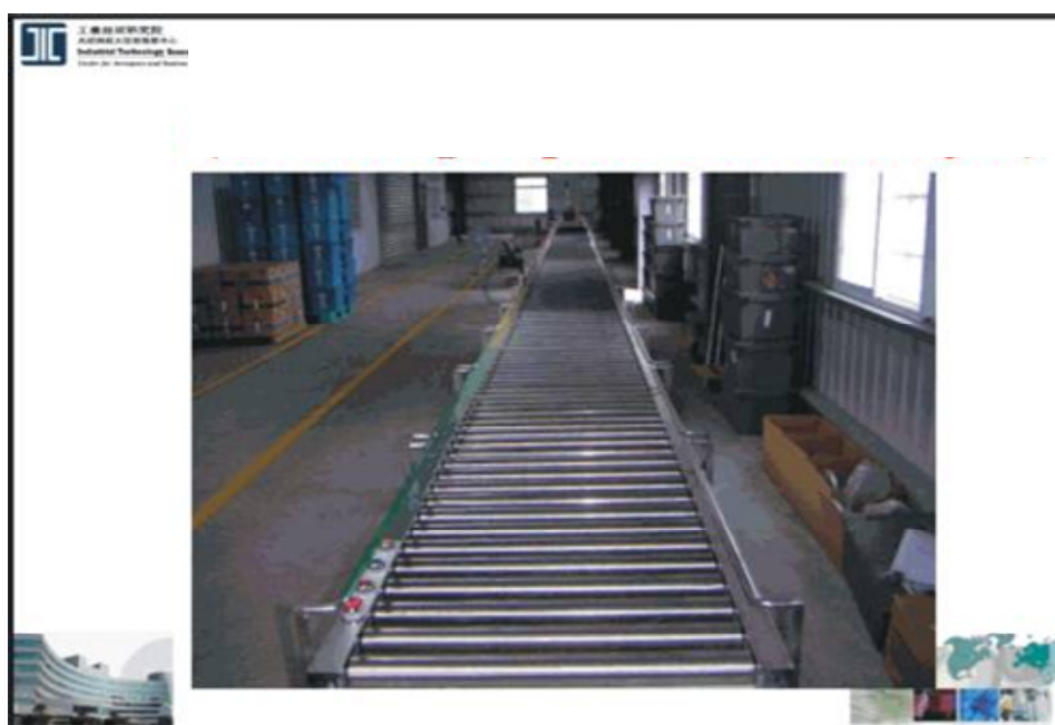
圖 4.13 RFID 紙箱高速讀取測試機
