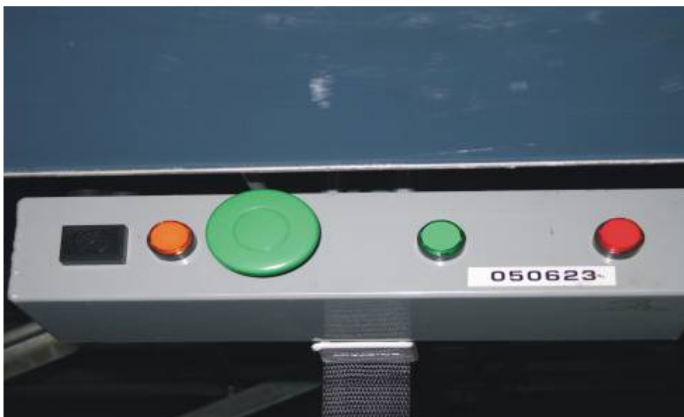
圖 2.20 RFID 天線燈號顯示面版
