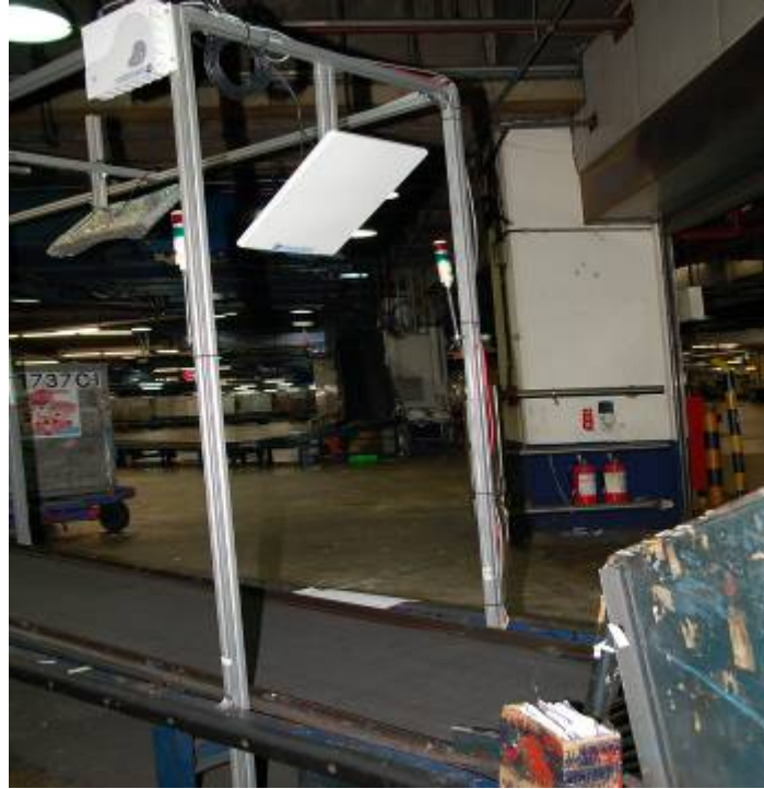
圖 8.4 安裝在行李輸送帶連接道之 RFID R3
