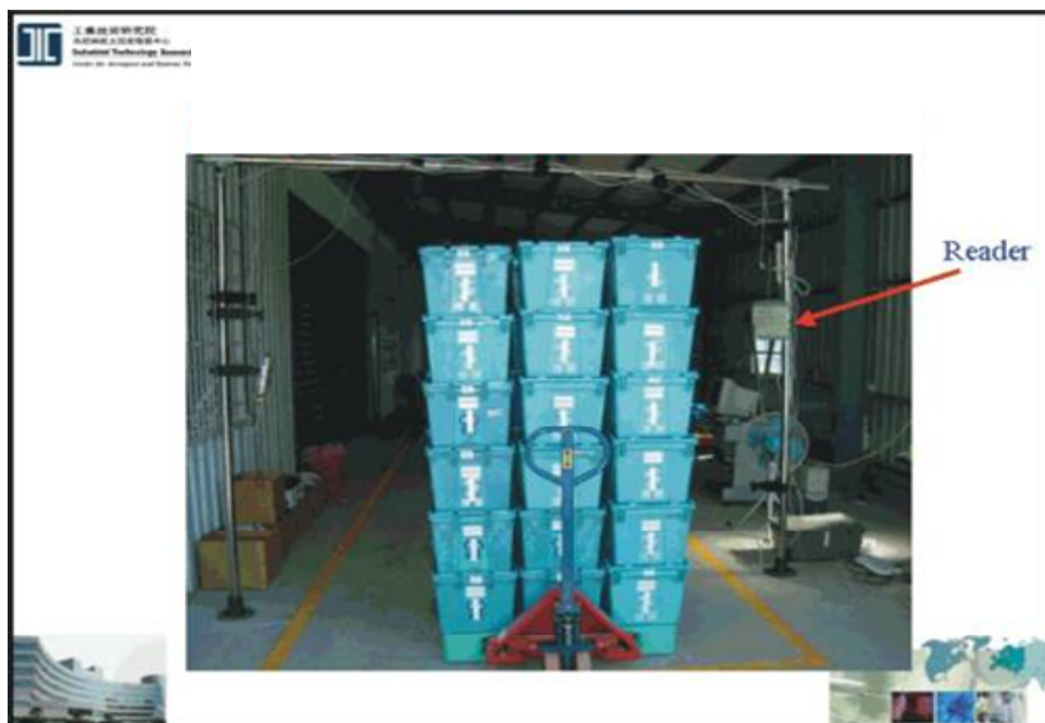
圖 4.12 RFID 讀取率測試閘口
