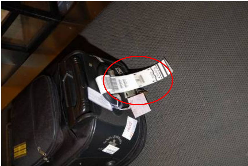
圖 8.8 經印表機列印具有 RFID Tag 之行李條
