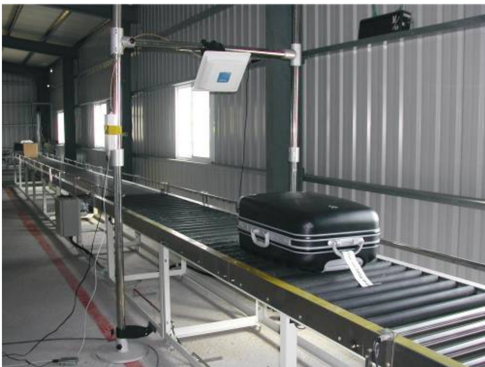
圖 5.24 RFID 行李條貼附於行李箱遠離天線處
