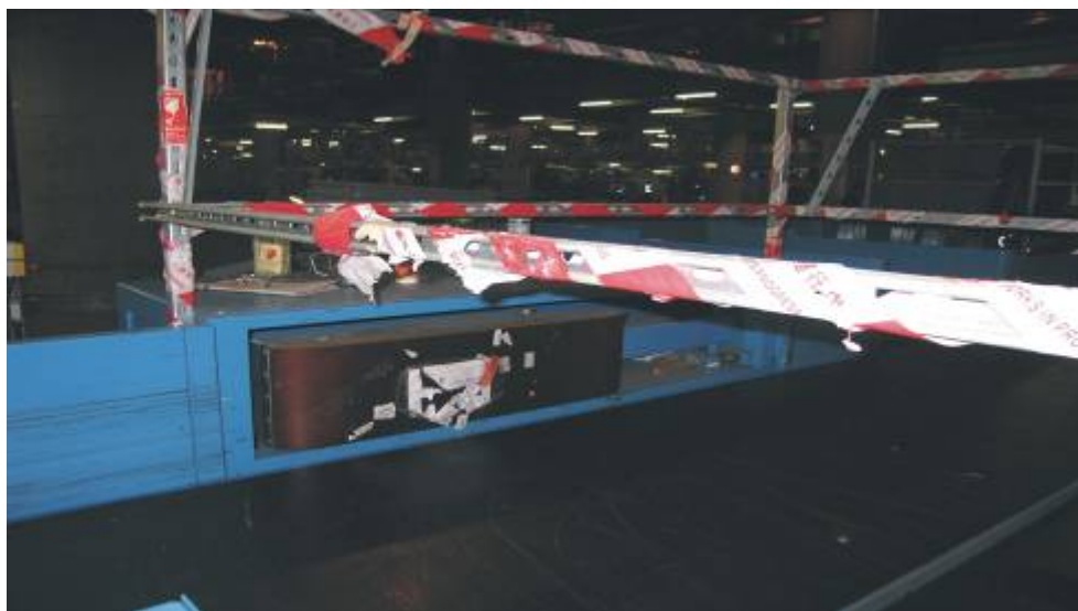
圖 2.16 託運行李 RFID Tag 資料無法辨認時推出輸送帶的裝備
