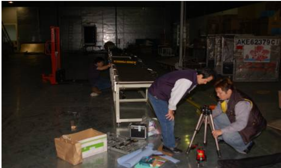
圖 7.10 模擬實驗室行李輸送帶安裝與校準
