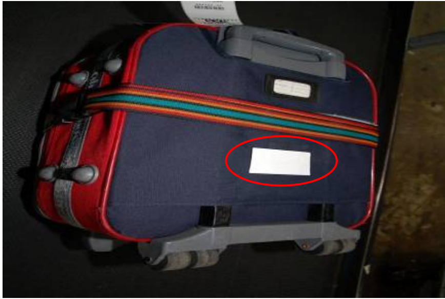
圖 8.7 經 Barcode-RFID 轉換器寫入 LPN 之工研院自製 Tag
