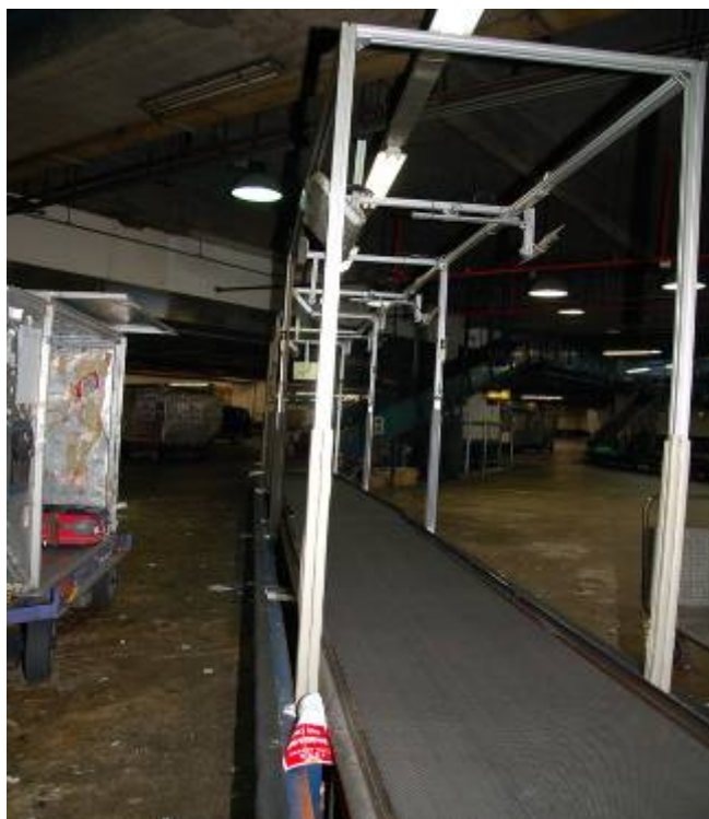
圖 8.5 行李卸載道 2 組 RFID Readers
