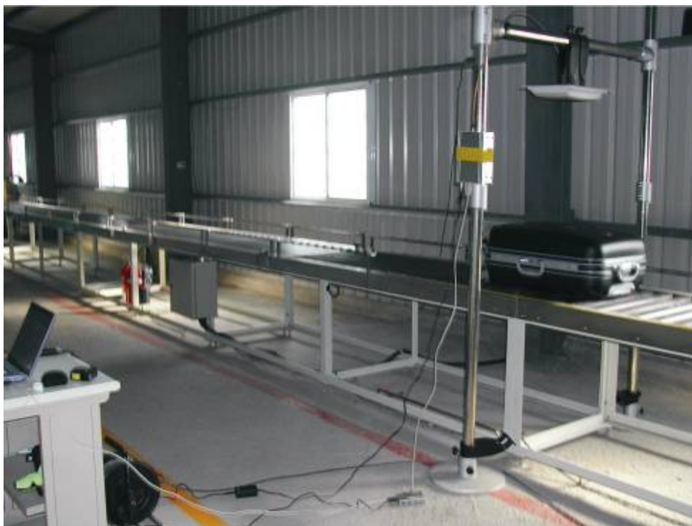
圖 5.19 RFID Tag 寫入驗測硬體相關配置
