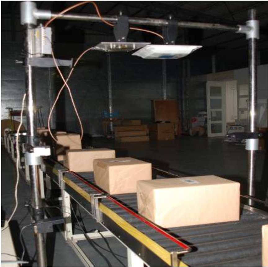
圖 6.6 Golden Tags 檢測門 12 面向驗測狀況
