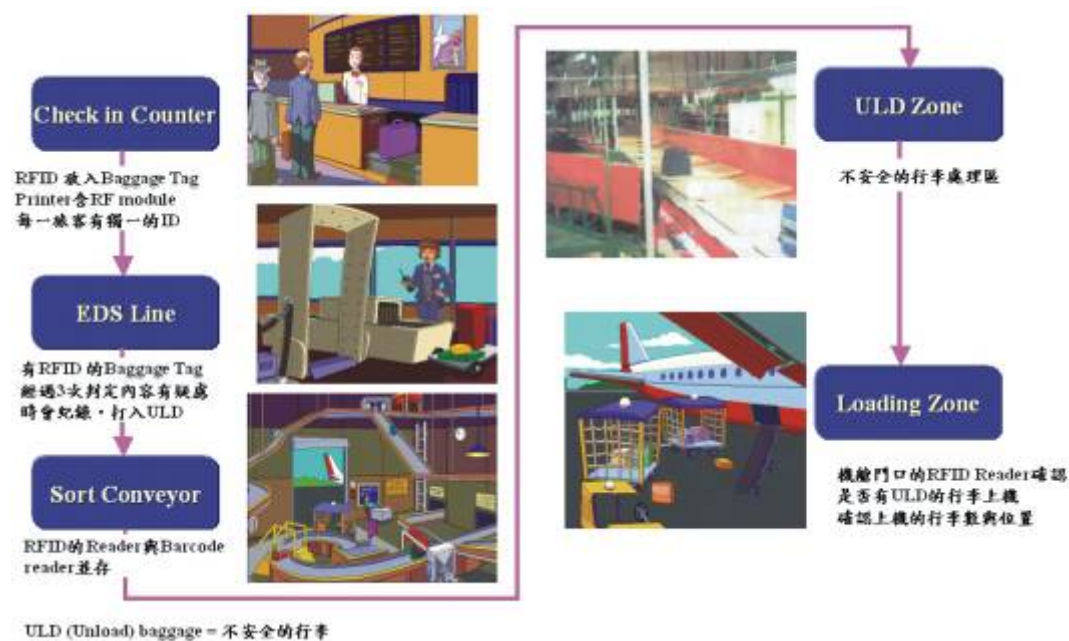
圖 2.8 香港機場之行李應用 RFID 技術系統示意圖
