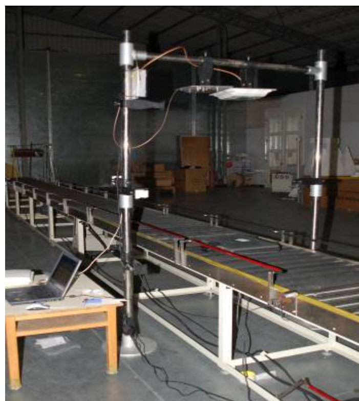
圖 6.5 Golden Tags 檢測門架設結構
