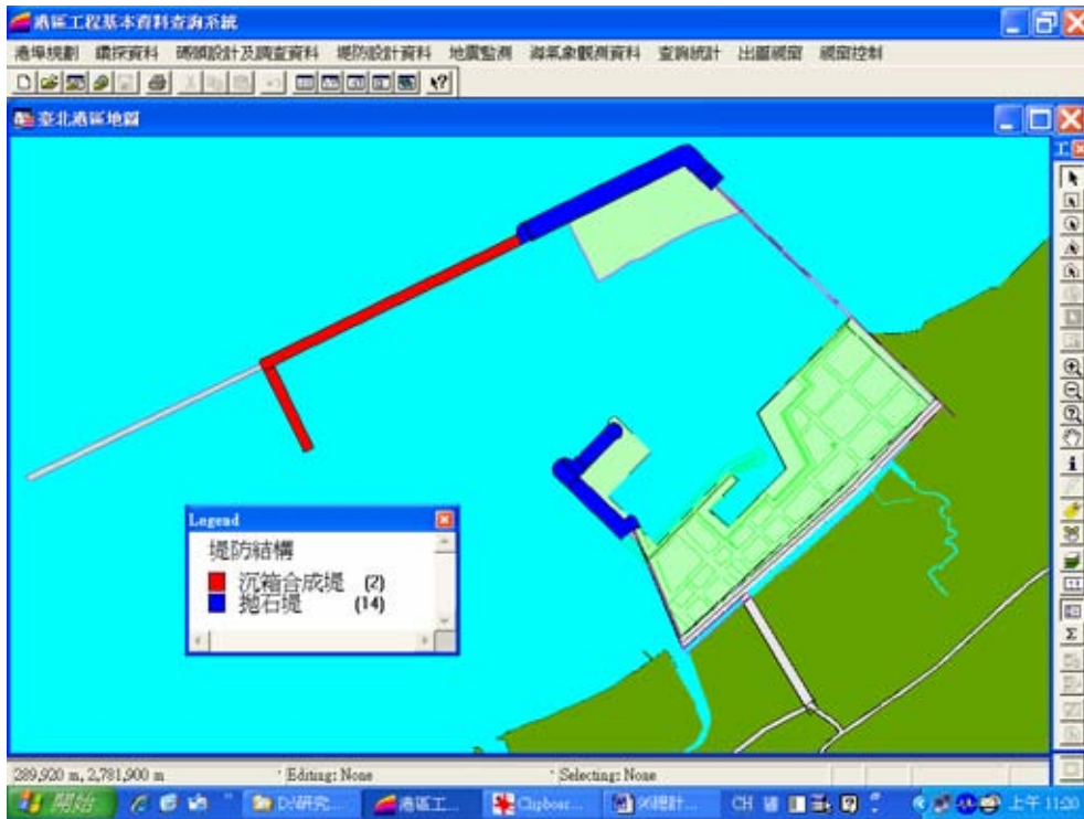
圖10-4 臺北港區堤防結構型式主題圖
