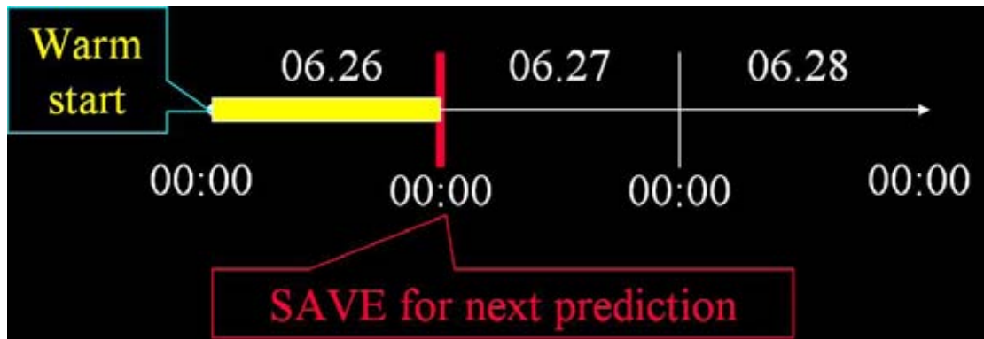
圖 3-2 近岸海象數值模擬及預警系統每日線上作業範例
