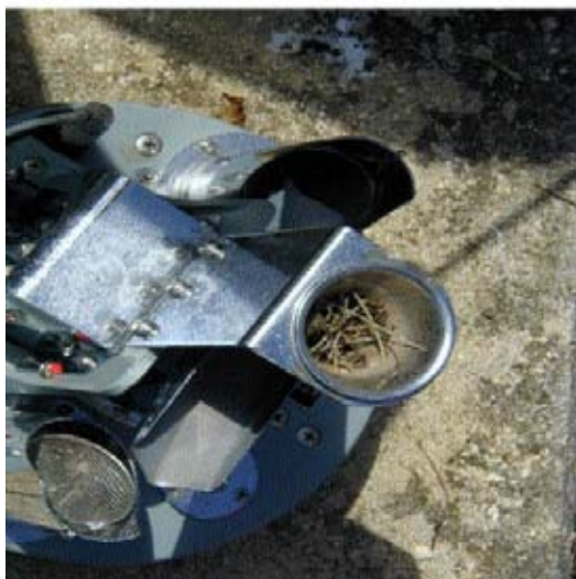
圖 4.8 落葉落於受水孔內之情形
