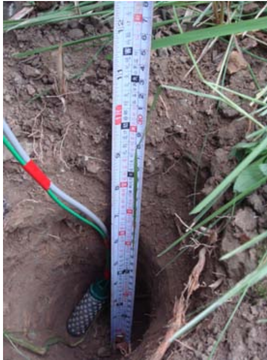
圖 4.3 將感應器放入洞的底部（深度約為 30cm）
