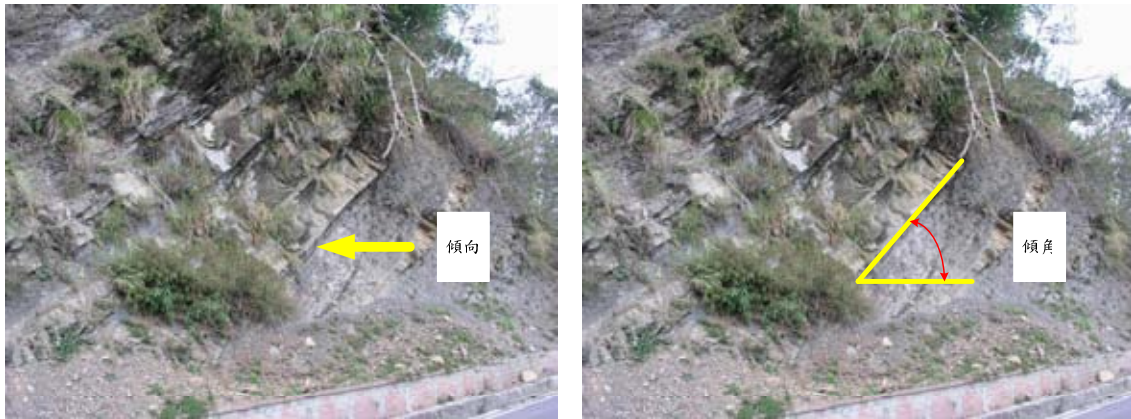
圖 3.6 岩層位態量化示意圖
