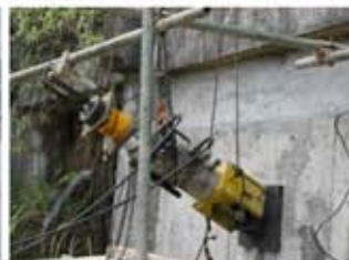
揚起試驗拉至破壞
