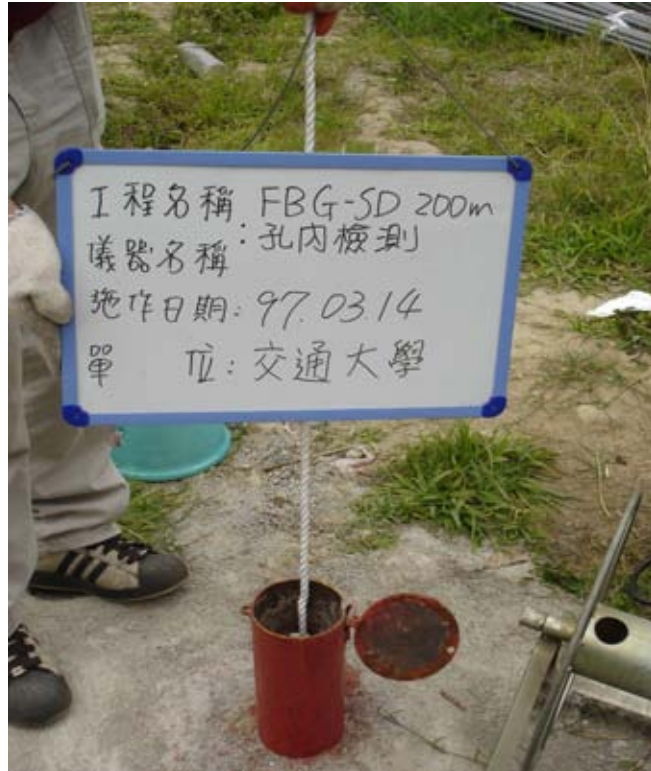
圖 2.3 IHMT-01 200m 傾斜觀測管深度檢測
