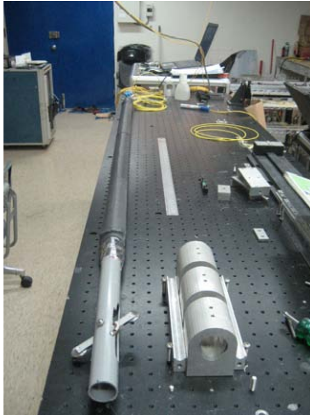
圖 3.8 光纖拉伸計固定於 PVC 管
