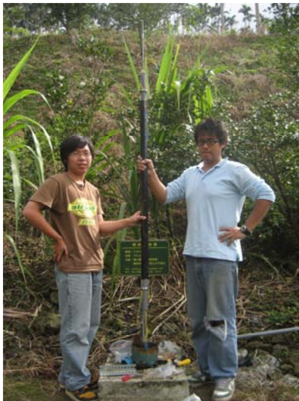
圖 4.14 改良式 BOTDR 拉伸計現場安裝
