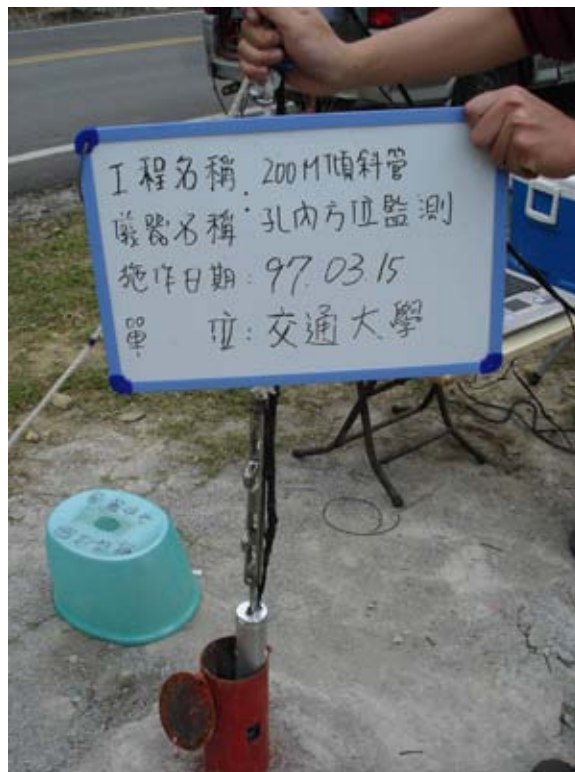
探管置入傾斜管
