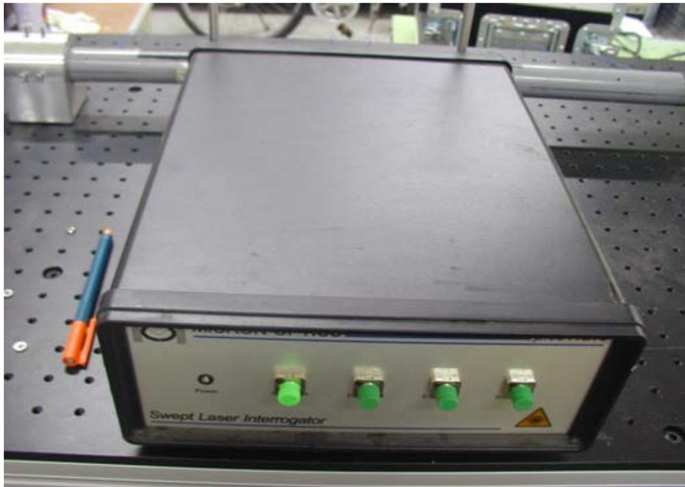
圖 4.9 光纖光柵訊號擷取系統
