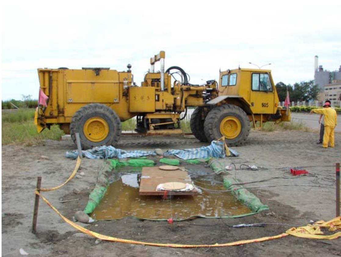
圖 1.4 現地棧橋式碼頭動態液化試驗配置圖
