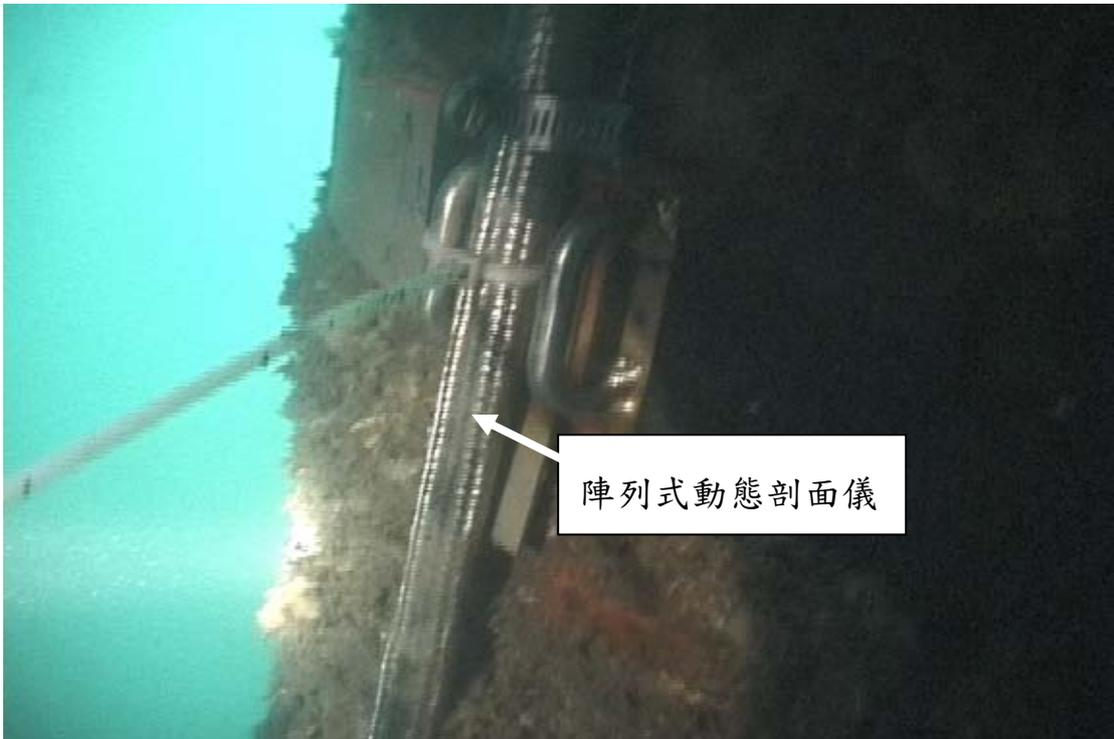
圖 4.18 陣列式動態剖面儀連結於套環完成圖
