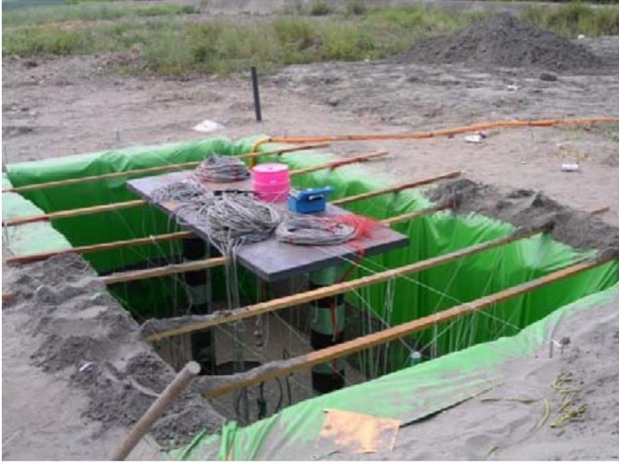
圖 5.8 試體回填-現地水中質落法
