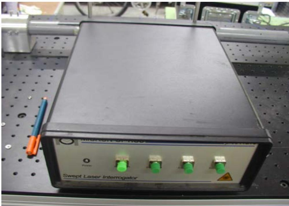
圖 7.9 光纖光柵訊號擷取系統
