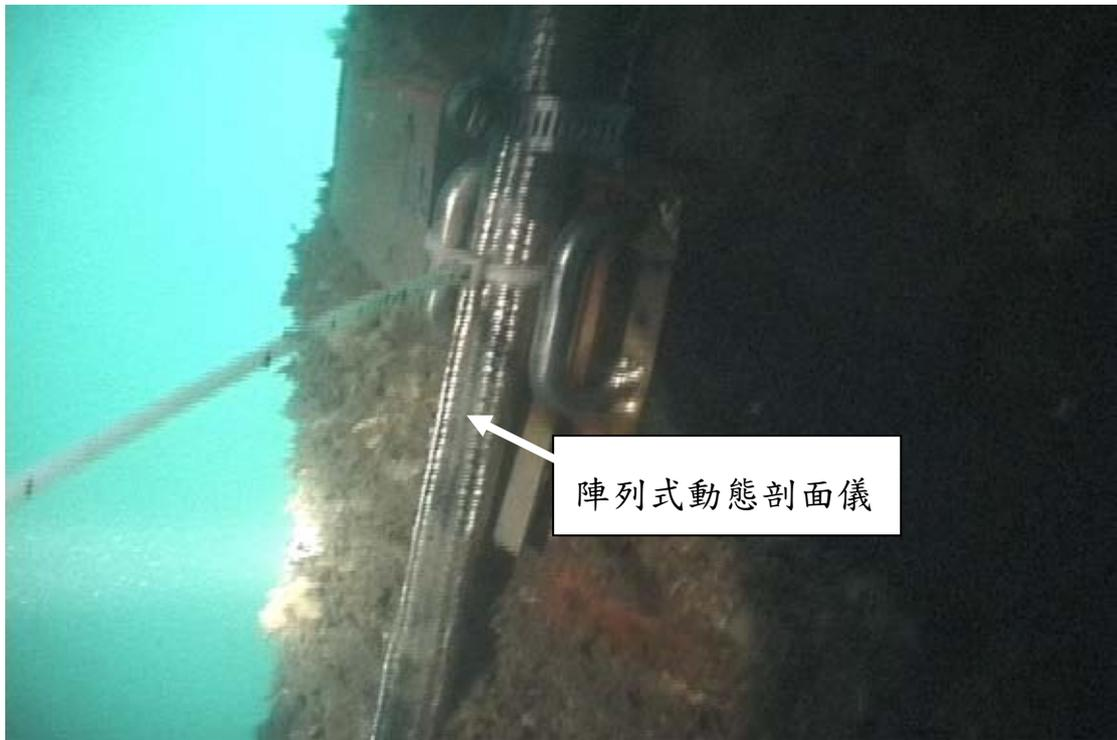
圖 7.18 陣列式動態剖面儀連結於套環完成圖
