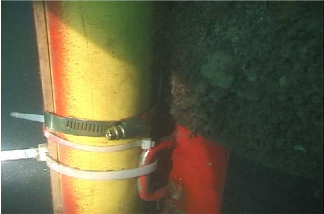
圖 7.19 光纖基樁變位感測元件連結於套環完成圖
