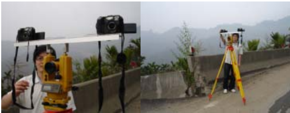
圖 5 - 11 全測站經緯儀與數位相機整合作業情形
