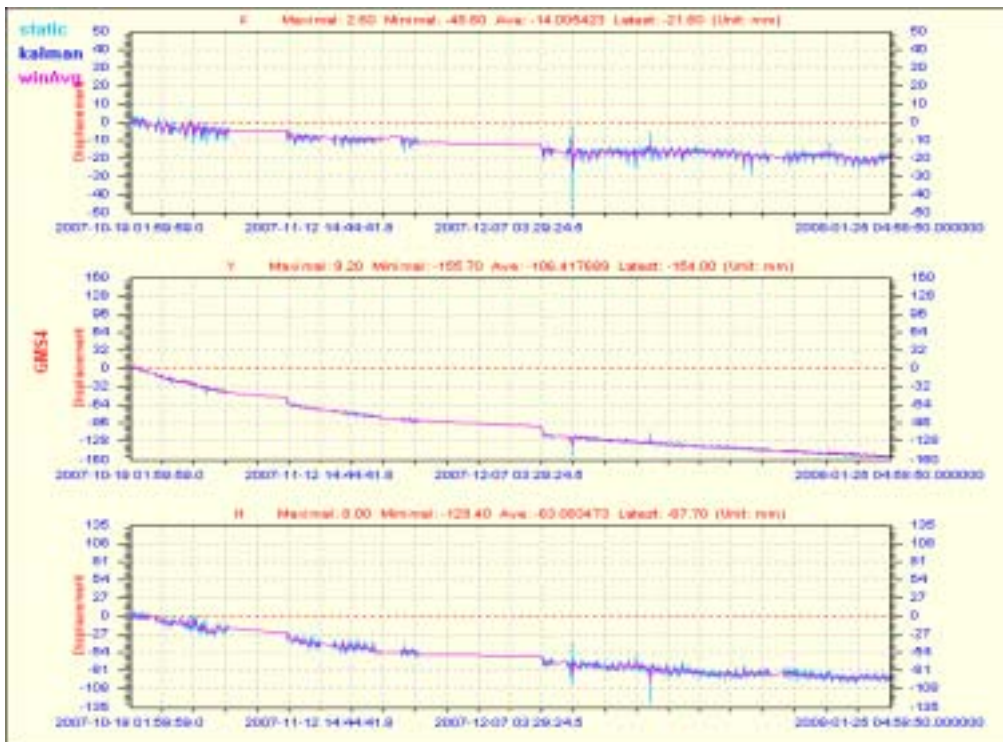
圖 3 - 23 道路邊坡自動化監測系統 (第四號天線 2007/10/19~2008/1/25)
