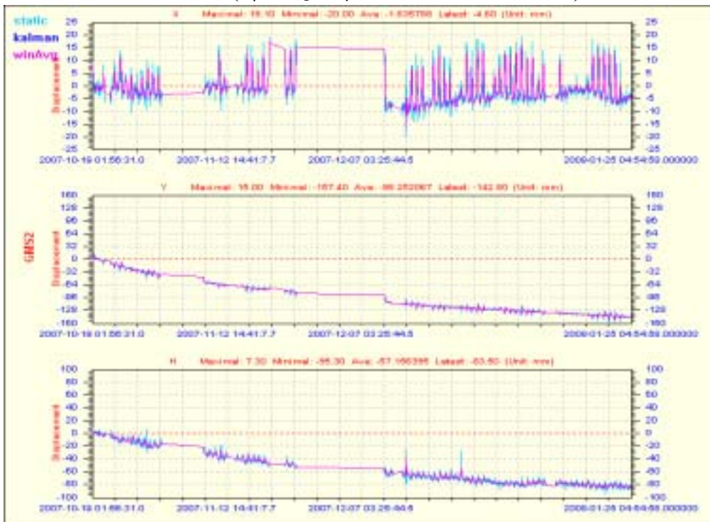
圖 3 - 21 道路邊坡自動化監測系統 (第二號天線 2007/10/19~2008/1/25)
