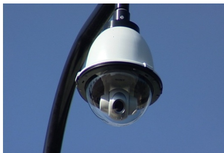
圖 3.90 攝影機吊架與室外保護罩
