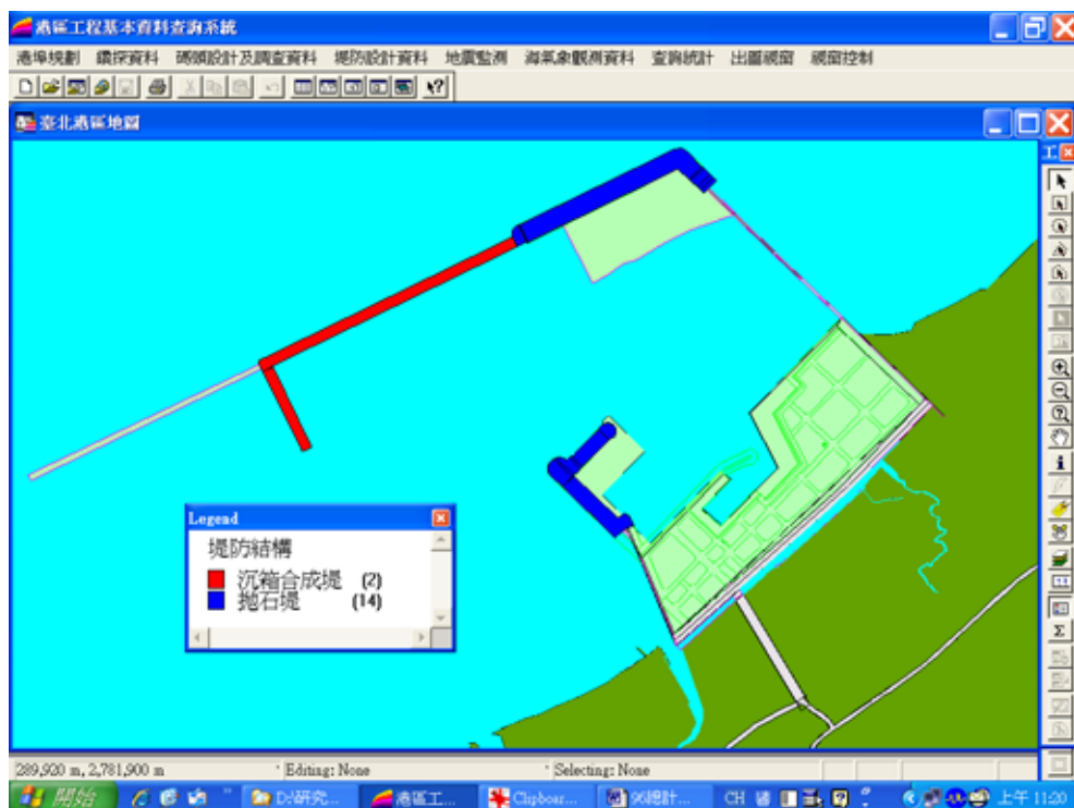
圖3-5 臺北港區堤防結構型式主題圖
