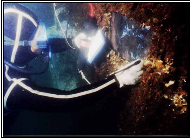
圖 3.4 水面下量測鋼板樁厚度之情形
