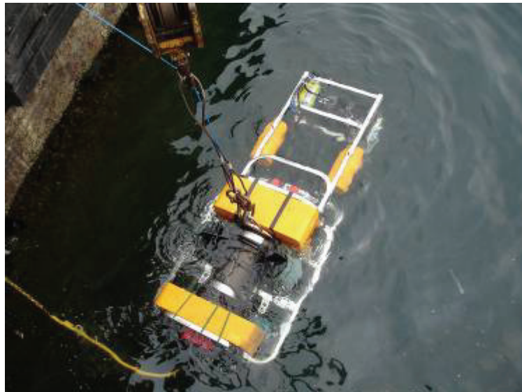
圖 15 港灣結構物水下觀測實驗
