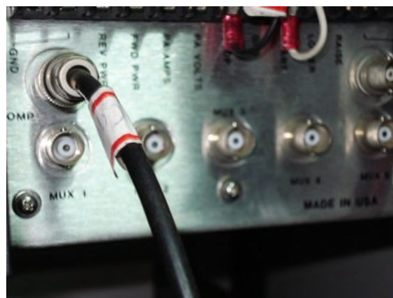
圖 3.3-9 發射機背面接頭(接 Mux 1 接頭)(花蓮台)
