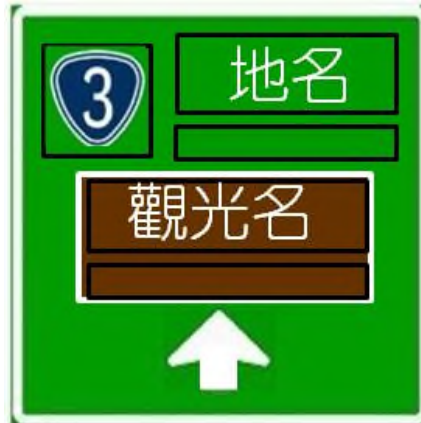
圖 3.1-5 設置規則指 22.5 門架式地名方向嵌入式資訊示意圖
