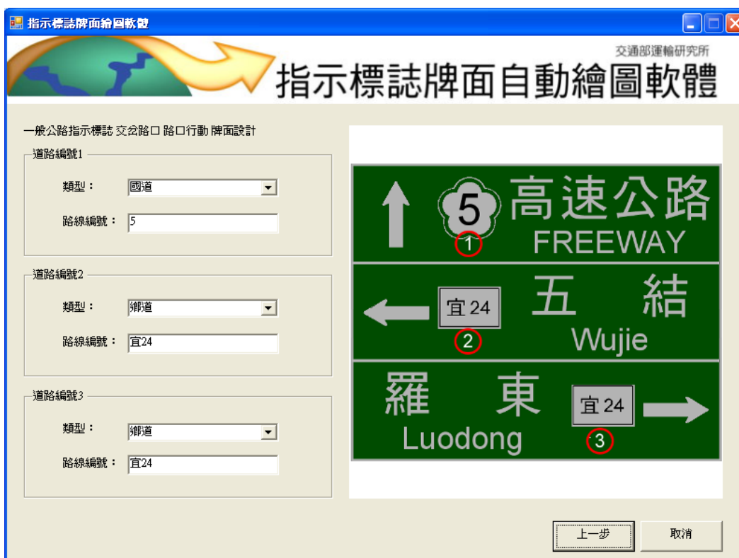
圖 6.3-6 道路指示標誌牌面道路編號編修畫面
