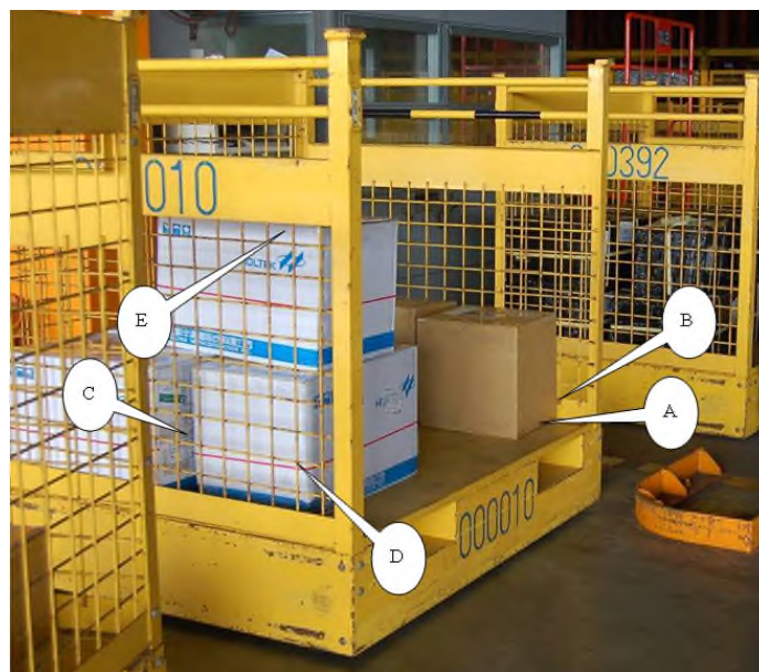
圖 7.69 鐵籠對不同電子標籤位置時讀取率的影響
