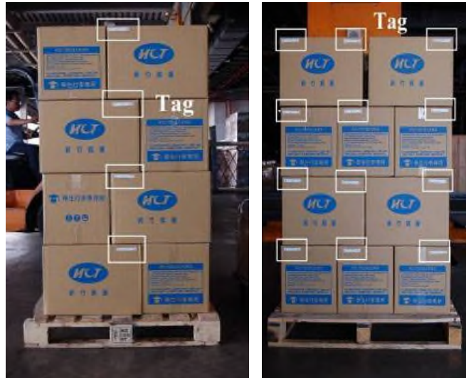
圖 7.54 模擬棧板貨進倉測試所用之棧板
