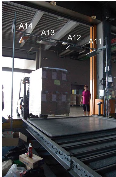
圖 7.114 棧板貨進倉節點天線架構實體圖(調整前)
