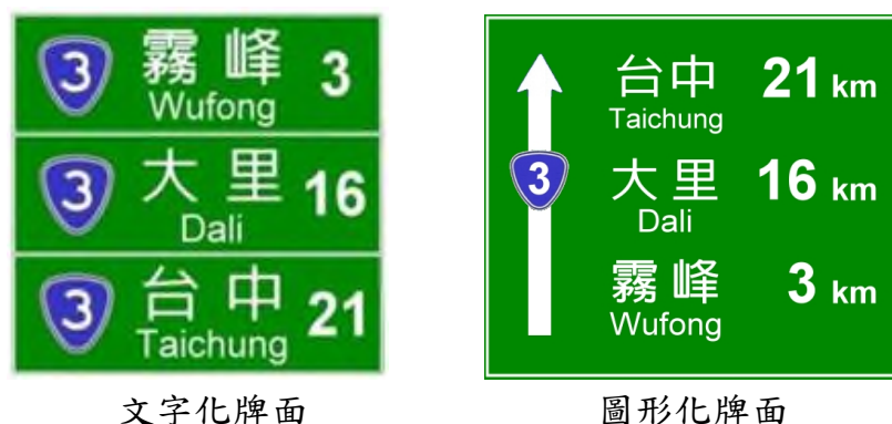
圖 2.3-4 地名里程確認牌面編排方式示意圖
