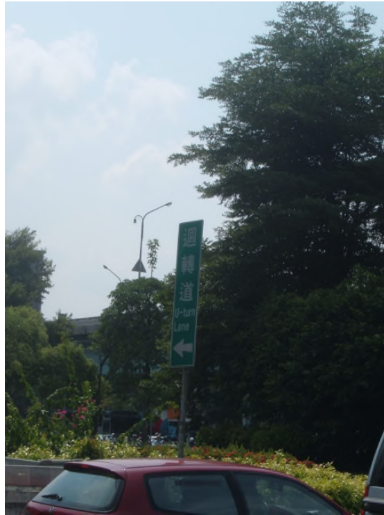
圖 A4.1-2 單柱立式標誌桿例圖
