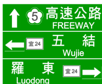
圖 2.3-2 文字化牌面編排方式示意圖
