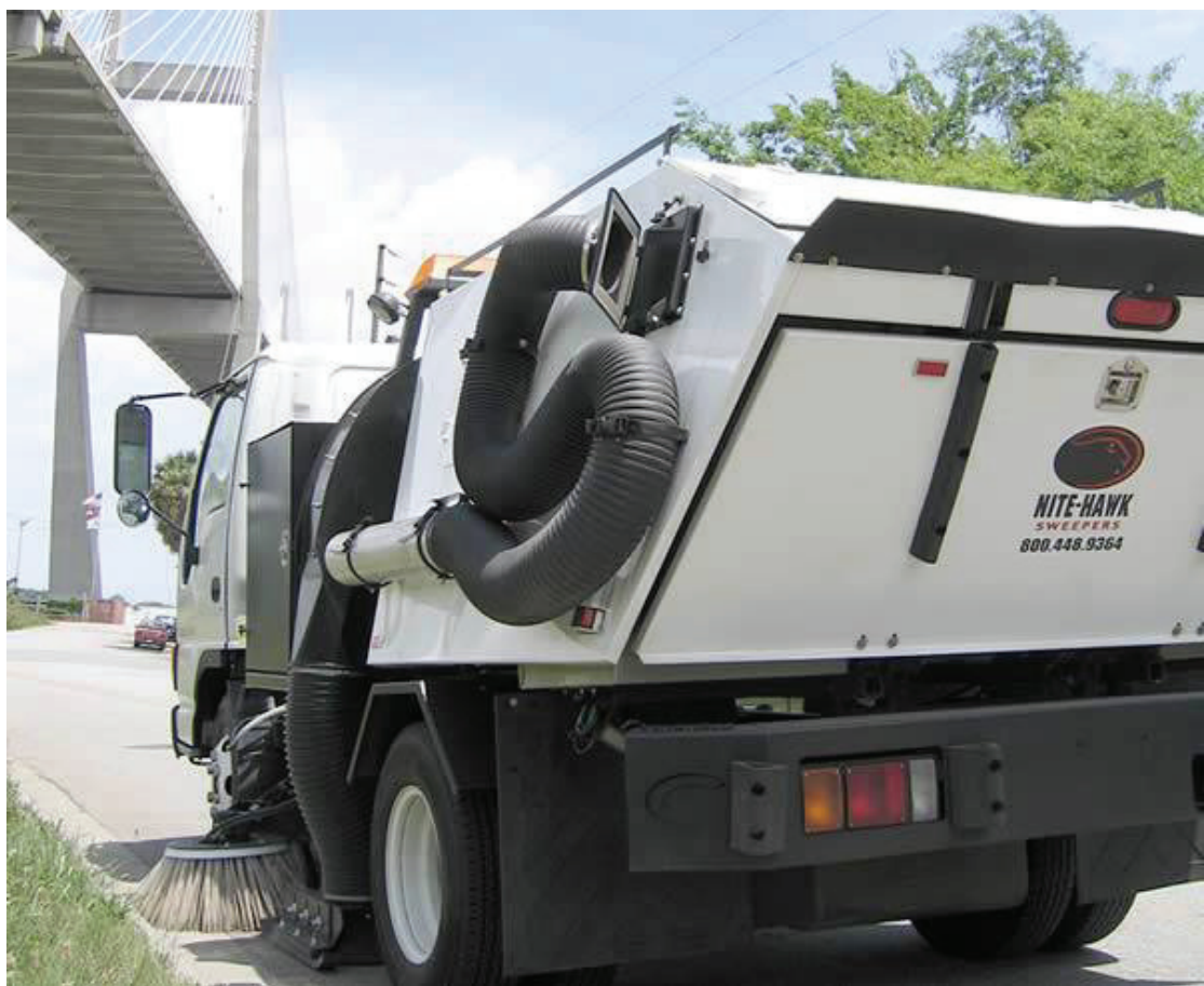
圖 2-46 Nite-Hawk 掃街車後方之真空吸管
