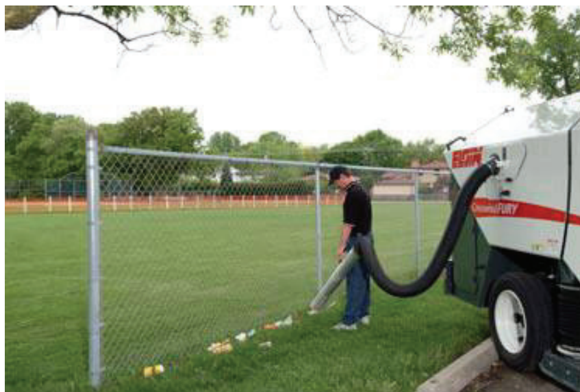
圖 2-55 Crosswind Fury 系列掃街車可外接橡膠吸管吸除垃圾
