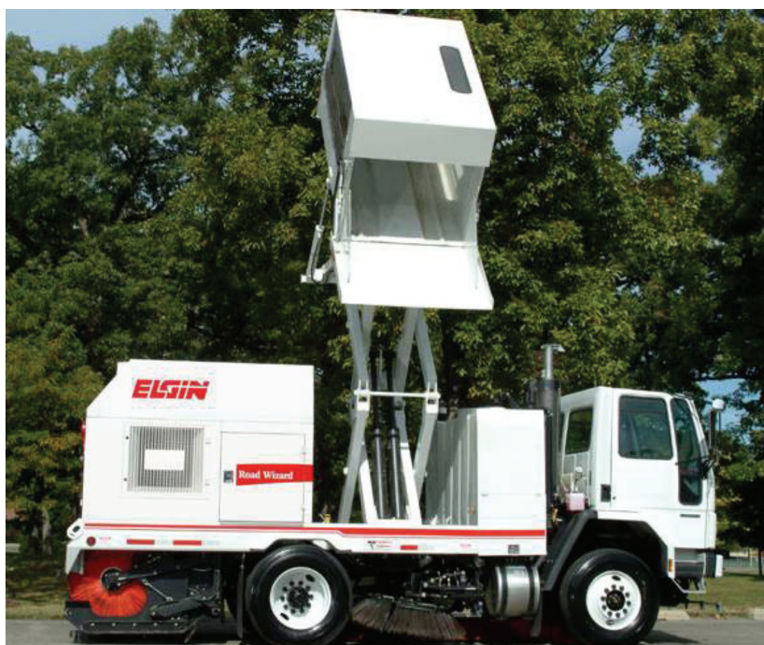
圖 2-56 Road Wizard 系列掃街車(4 輪，可達高速公路行駛速度)
