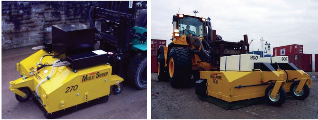
圖 2-61 車載外掛式掃街機具
