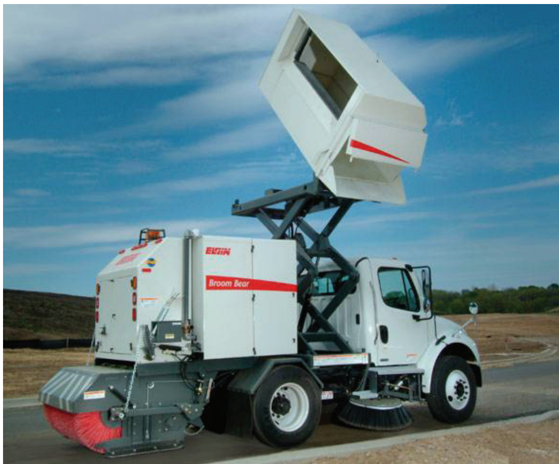
圖 2-50 Broom Bear 系列掃街車(4 輪，可達高速公路行駛速度)
