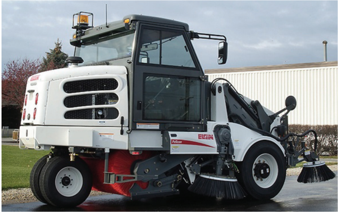
圖 2-48 Pelican 系列掃街車(3 輪，最高時速 32km/h)
