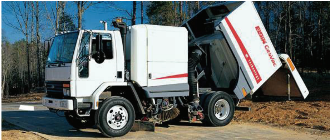
圖 2-51 GeoVac 系列掃街車(4 輪，可達高速公路行駛速度)
