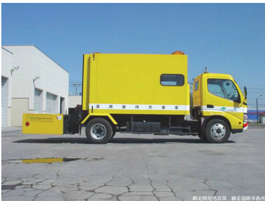
圖 3-19 日本国土交通省網走開發建設部道路維持作業車安裝之緩撞車
