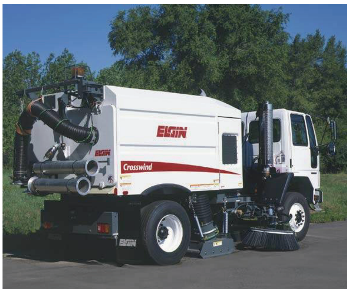
圖 2-53 Crosswind 系列掃街車(4 輪，可達高速公路行駛速度)
