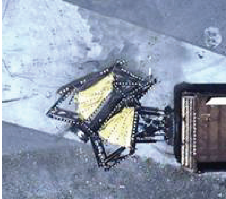
圖 3-10 美國緩撞車撞擊後變形狀態-Energy Absorption Systems, Inc.(三)
