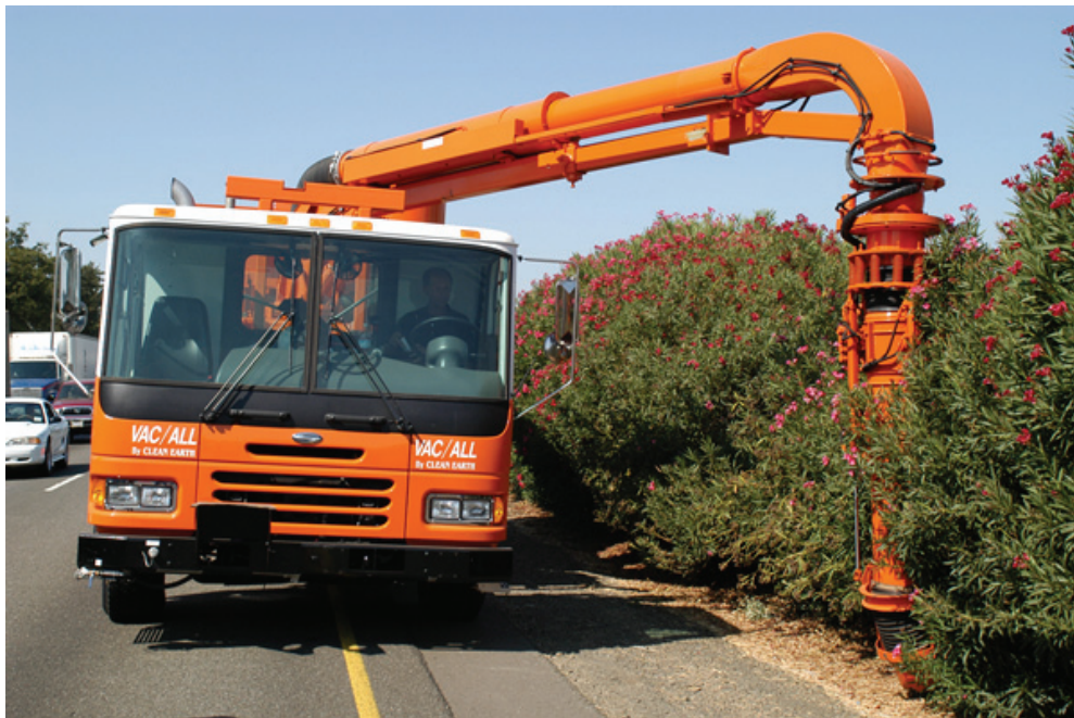
圖 2-42 路側垃圾真空自動吸取車實際作業情形
