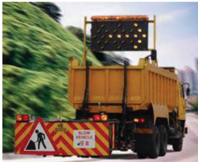
圖 3-1 香港利用「緩撞車」為工程車護航
