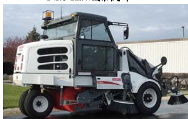
Elgin Sweeper掃街車(Pelican系列，32km/h)
