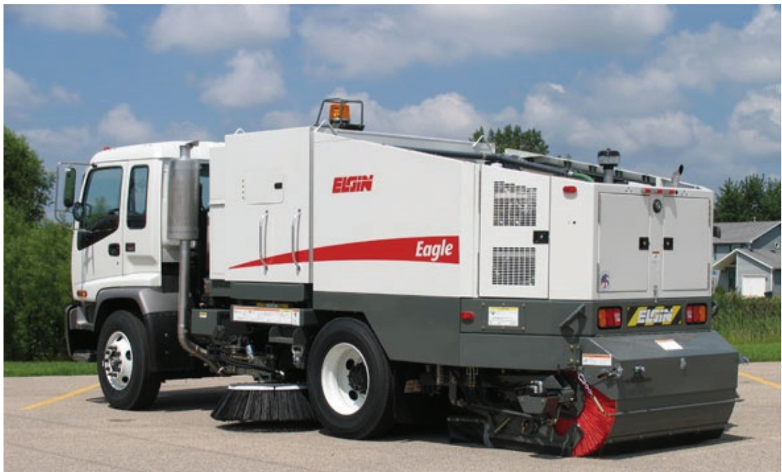
圖 2-49 Eagle 系列掃街車(3 輪，可達高速公路行駛速度)
