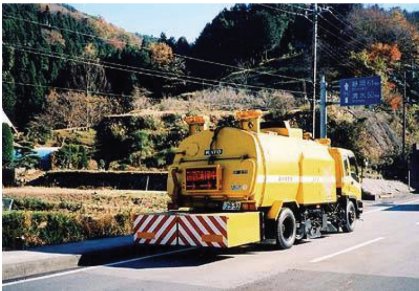
圖 3-16 日本国土交通省甲府河川國道事務所路面清掃車安裝之緩撞車
