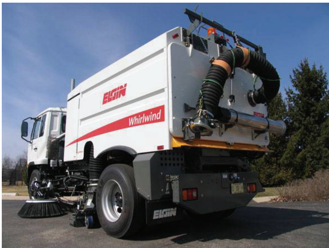
圖 2-52 Whirlwind 系列掃街車(4 輪，可達高速公路行駛速度)
