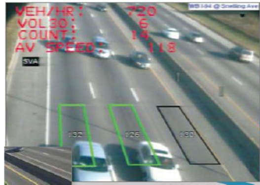
圖 3.1.1- 3 ISS-Autoscope 高速公路偵測示意圖
