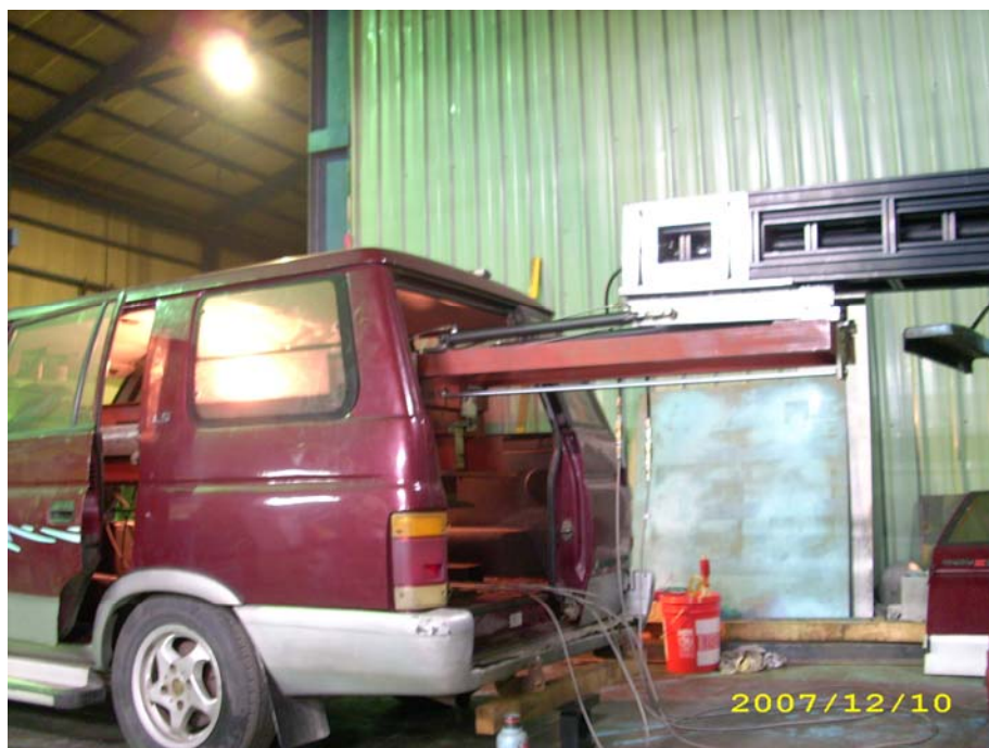
圖 5.6 機械手臂組裝後油壓推進測試(1)
