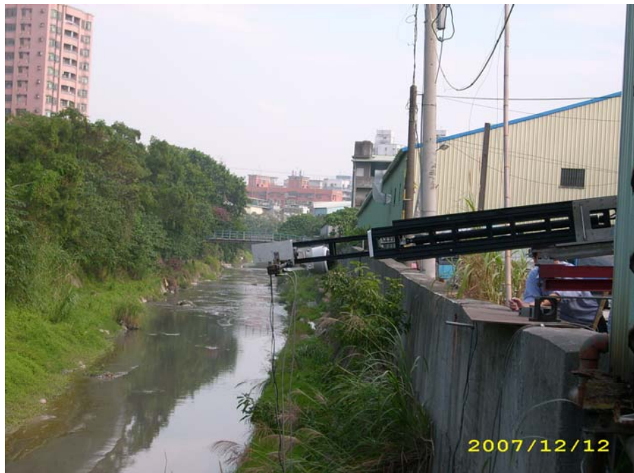
圖 5.9 橋梁檢測機械手臂室外測試—第 1 節臂外推延伸(1)
