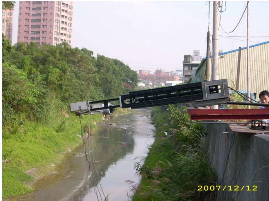
圖 5.10 橋梁檢測機械手臂室外測試—第 1 節臂外推延伸(2)
