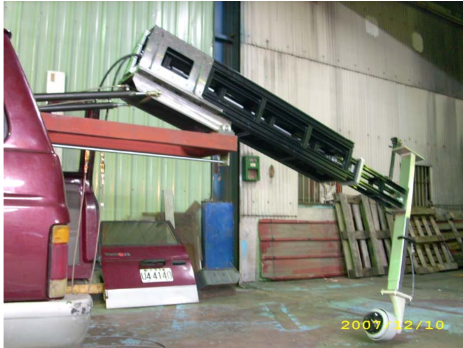
圖 5.8 機械手臂組裝後油壓推進測試(3)
