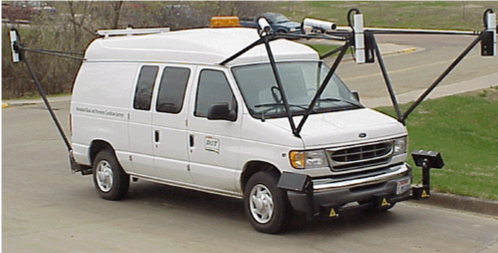
圖 2.27 南達科塔州之鋪面及道路影像錄影系統
