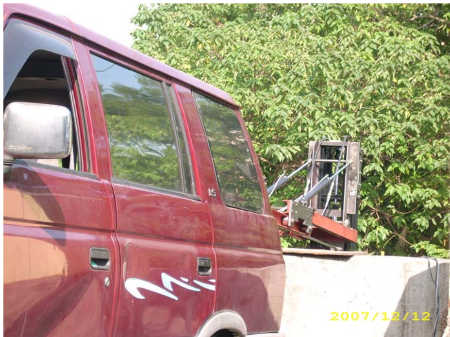
圖 5.11 橋梁檢測機械手臂室外測試—第 2 節臂旋轉 90 度
