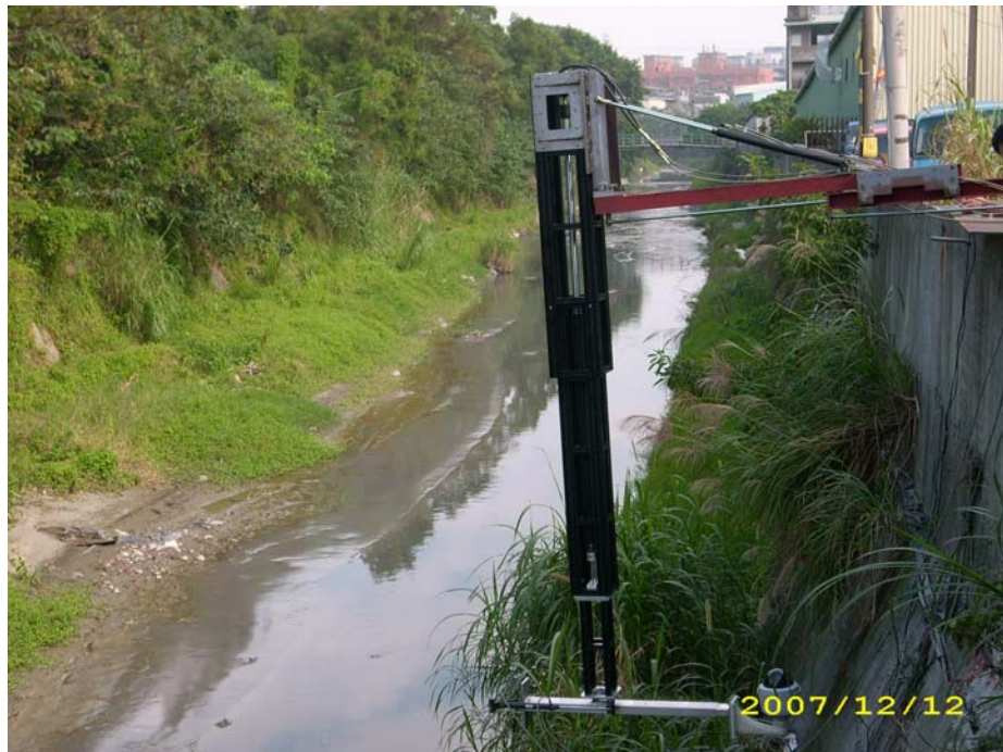
圖 5.13 橋梁檢測機械手臂室外測試—第 3 節臂旋轉 90 度
