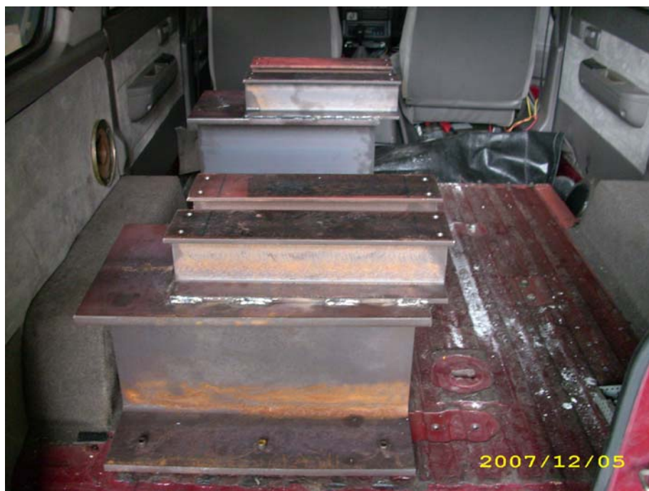
圖 5.2 機械手臂第 1 節與車廂結合處
