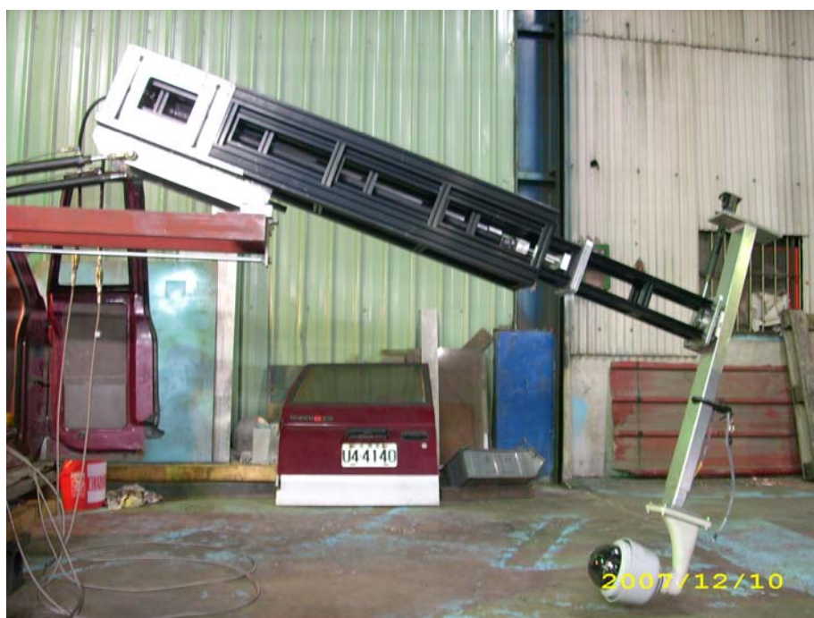
圖 5.7 機械手臂組裝後油壓推進測試(2)
