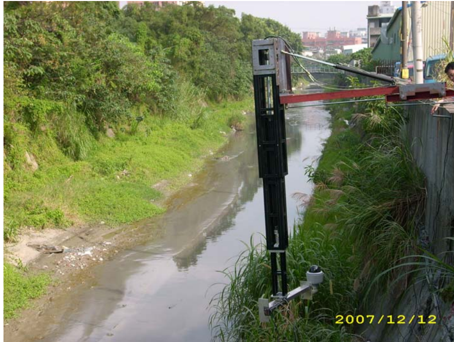
圖 5.12 橋梁檢測機械手臂室外測試—第 2 節臂向下延伸
