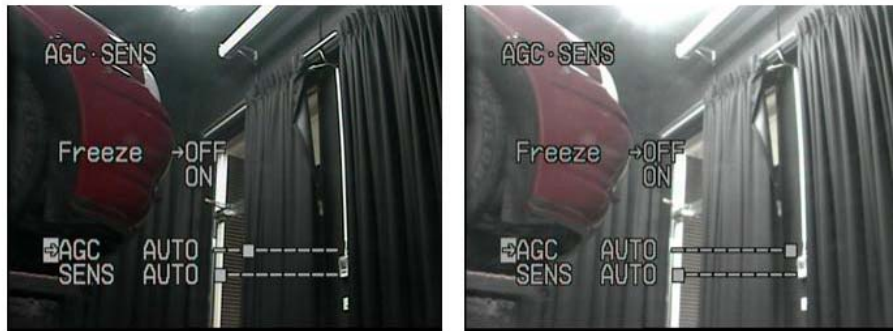
圖 3.13 充足光源環境下 Speed Dome 攝影機攝影品質(左右圖分別在高低照度下拍攝)
